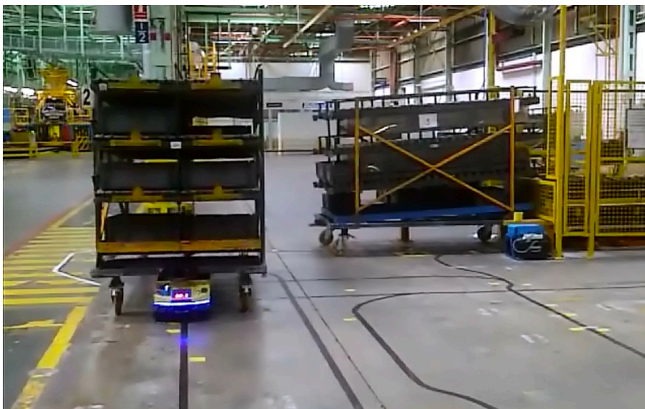
Figura 23 AGVs con tecnología de navegación de rutas fijas por electromagnetismo, fuente: clearpathrobotics
