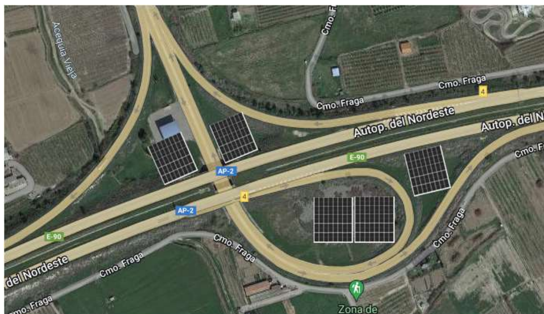
Ilustración 27. Planteamiento de placas solares en accesos. Fuente: Imagen de Google Maps: Autovía AP-2, Fraga
