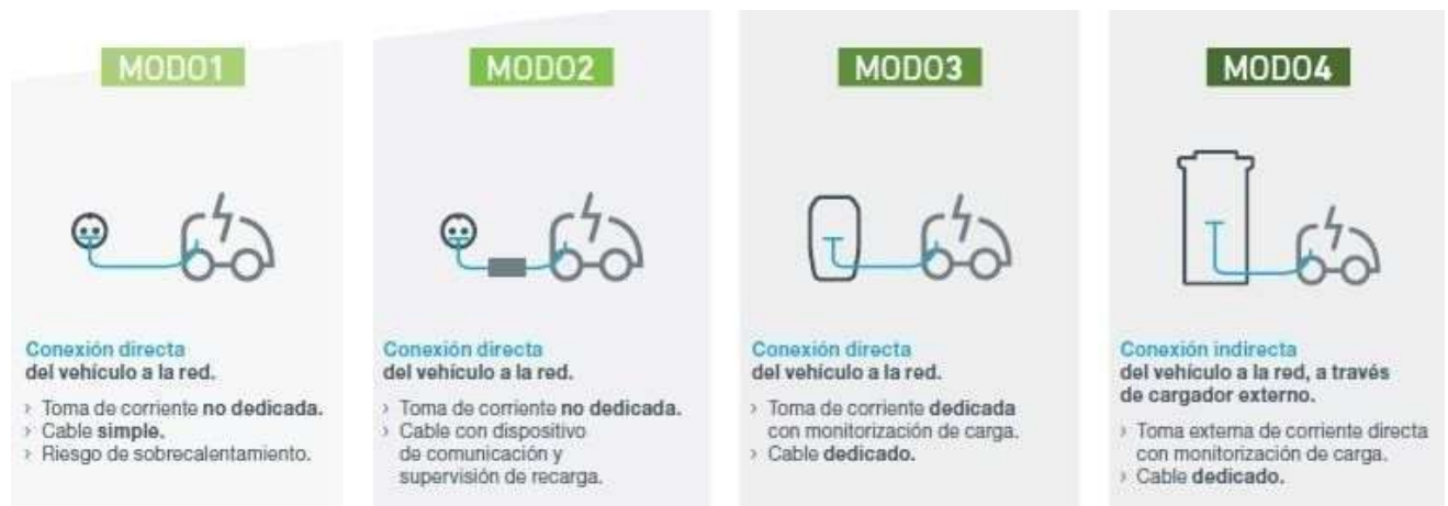
Ilustración 16. Modos de recarga de vehículos electrificados. Fuente: Wallbox
