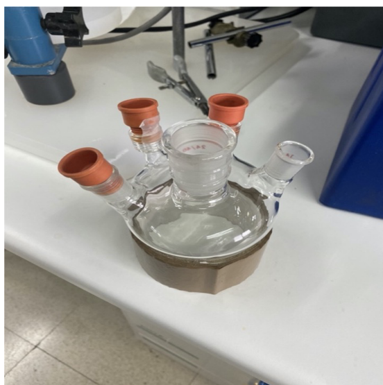
Figura 8 Imagen tomada en el laboratorio de la celda electroquímica adaptada y utilizada.
