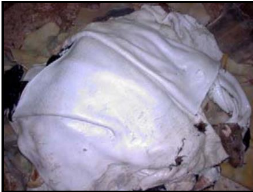
Anexo N° 15 – Pieles de vacuno luego de la operación de descarnado en máquina Curtiduría Orión S.A.C
