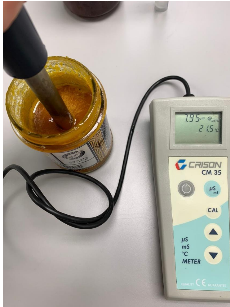
Figura 30. Medición de conductividad Fuente: elaboración propia
