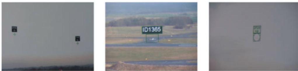
Figura 4: Aeronaves detectadas únicamente por los sistemas de vigilancia (izquierda); aeronave detectada únicamente por el sistema de cámaras de la torre remota (centro); aeronave con los datos del sistema de vigilancia y sistema de cámaras fusionados (derecha). [4]
