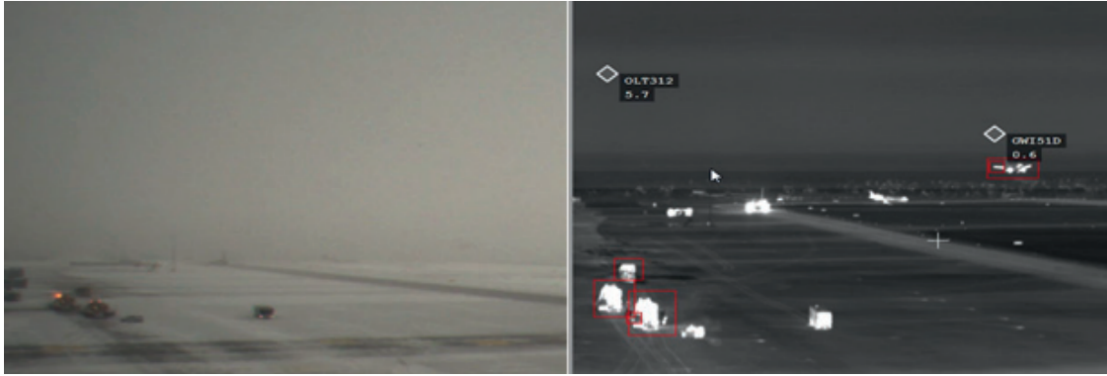
Figura 3: Vista desde una torre convencional en condiciones de baja visibilidad (izquierda) en comparación con la misma vista desde una torre remota, realizada por cámaras de infrarrojos y sistemas de detección e identificación de objetos (derecha). [4]
