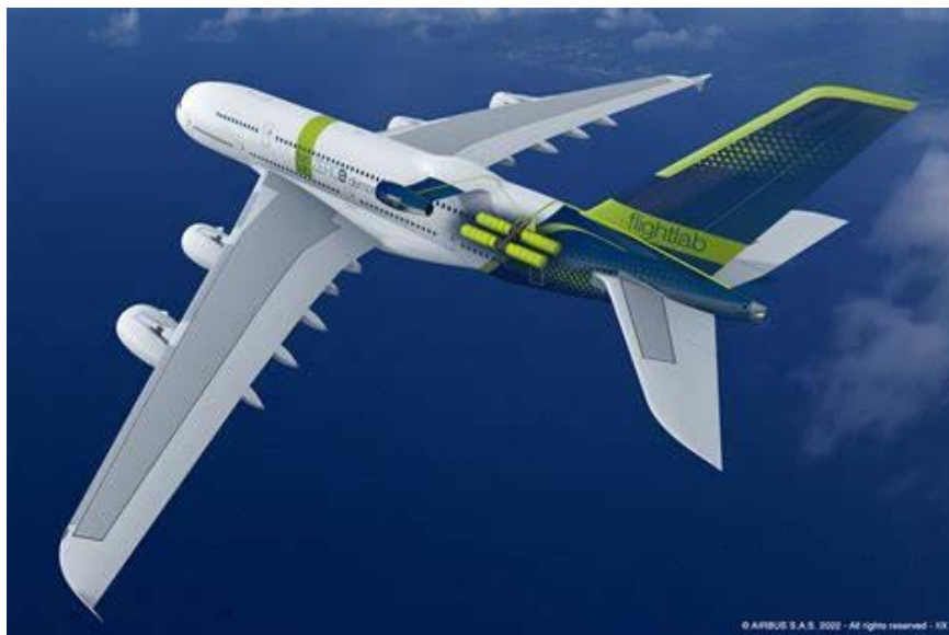
Figura 36. Concepto A380 MSN1 para testear tecnologías de hidrógeno [29].
