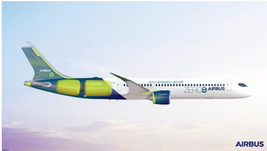
Figura 24. Ubicación de tanque de almacenamiento H 2 en avión de corto alcance [17].
