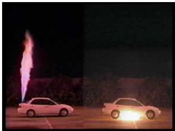
Figura 4. Comparación llamarada de hidrógeno vs gasolina [7].
