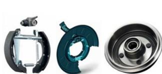
Figura 15.6. Elementos de un freno de tambor.
