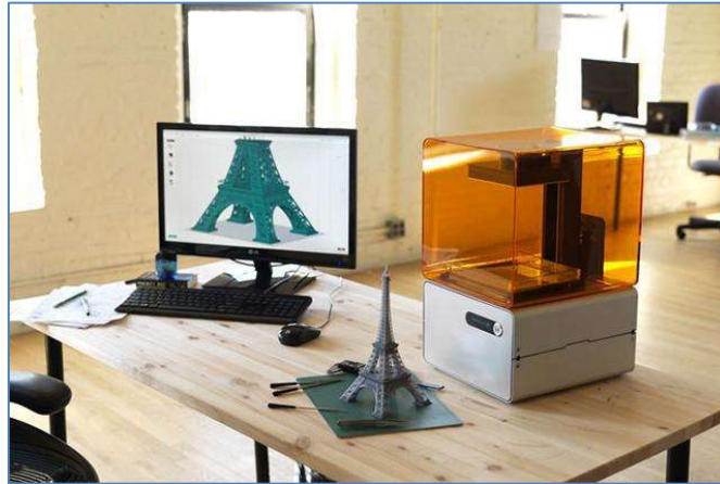
Ilustración 30 - Diseño en 3D para posterior impresión en impresora SLA.
