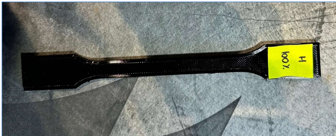
Ilustración 87 - Probeta de PETG con 100% de relleno. Fuente: Fotografía propia.
