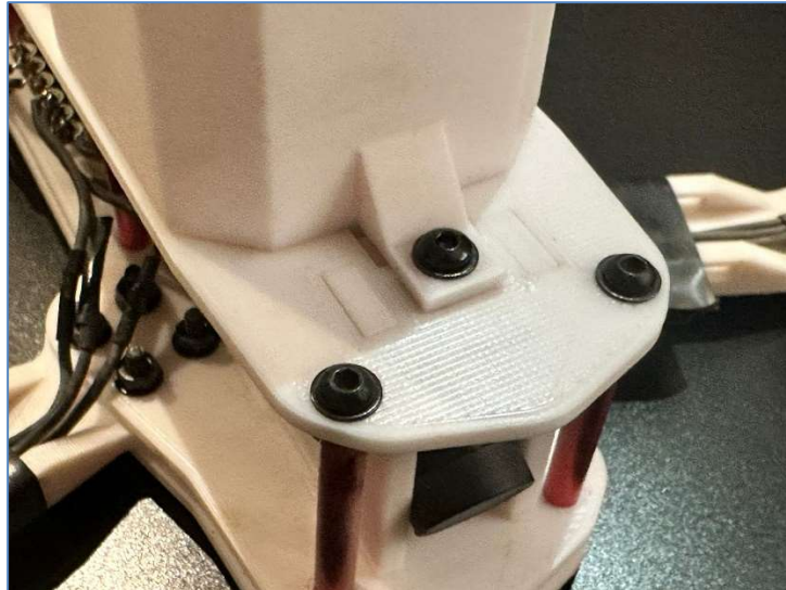
Ilustración 139 - Fijación final del adaptador dummy con tornillo en el taladro dedicado. Fuente: Fotografía propia.
