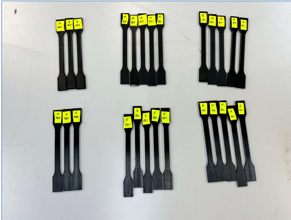
Ilustración 88 - Probetas fabricadas en PETG con diferentes rellenos. Fuente: Fotografía propia.
