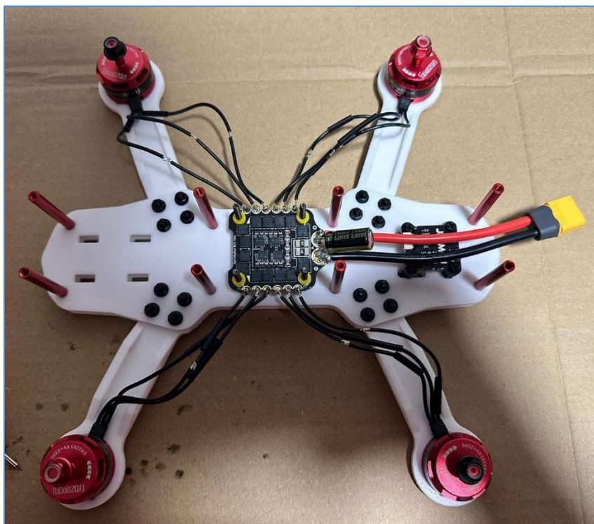
Ilustración 68 - Montaje de los motores, empalme y soldadura al stack. Fuente: Fotografía propia.
