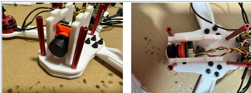
Ilustración 137 - Montaje de cámara FPV en los soportes e inserción en los alojamientos de la placa inferior. Fuente: Fotografías propias.
