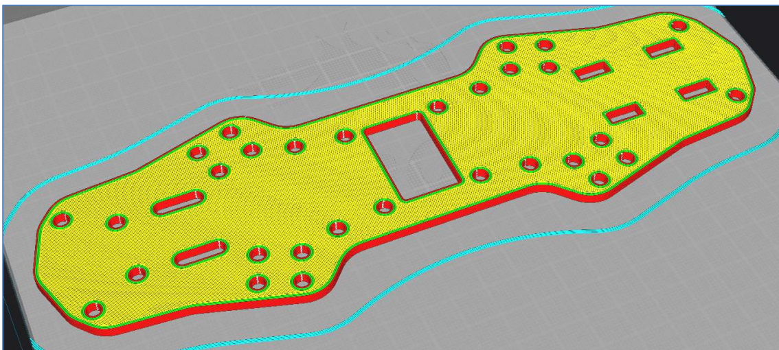
Ilustración 109 - Segmentación de la base en Ultimaker Cura. Fuente: Realización propia.
