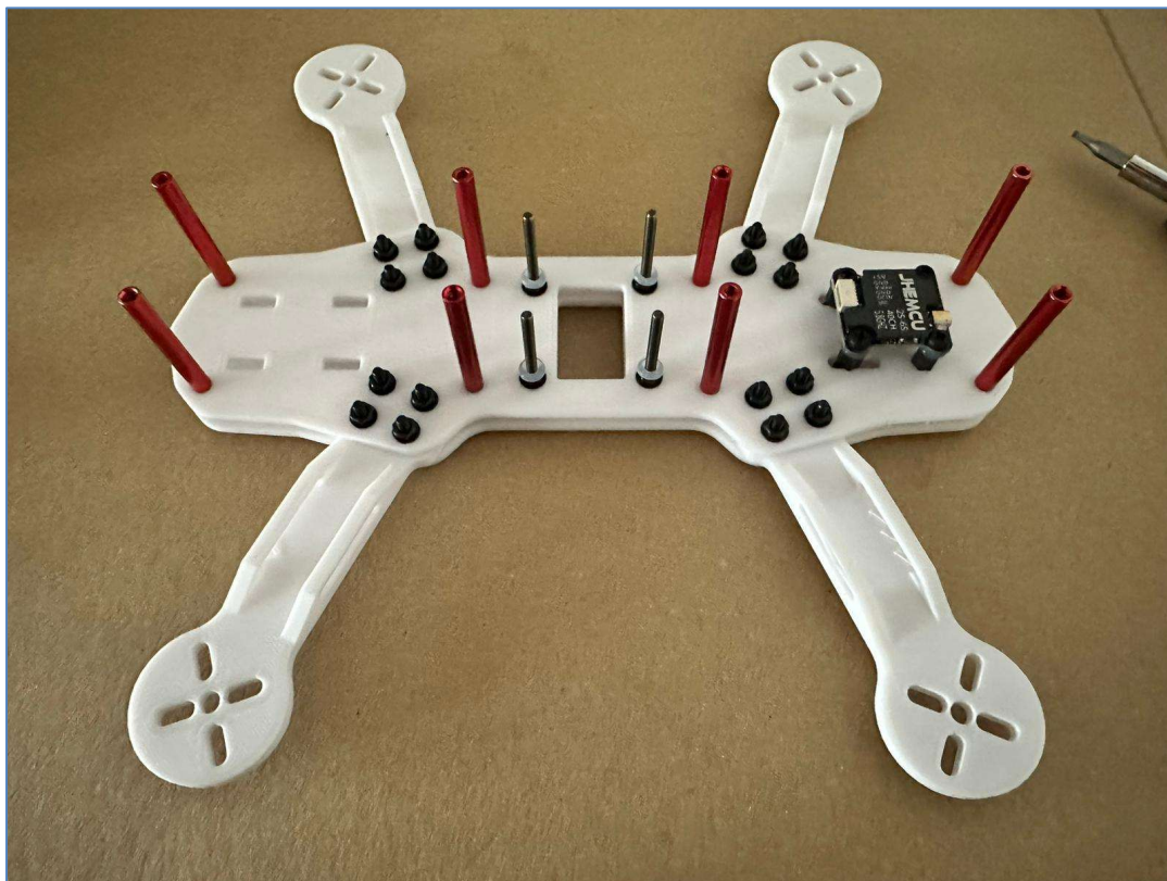
Ilustración 135 - Montaje de los brazos y las placas inferiores. Fuente: Fotografía propia.
