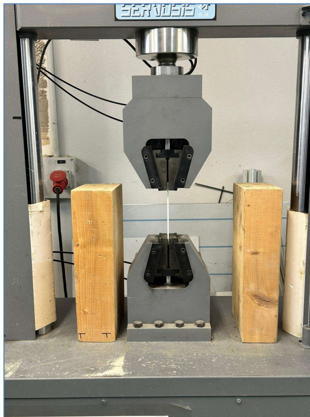
Ilustración 90 - Máquina utilizada en el ensayo de tracción. Fuente: Fotografía propia.
