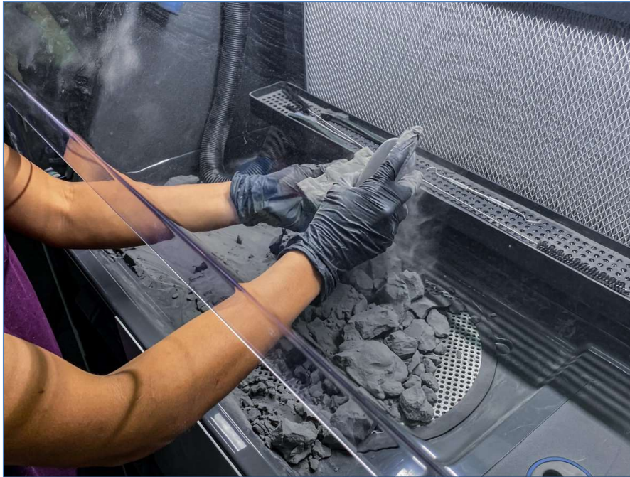
Ilustración 52 - Limpieza de pieza después de fabricarse en impresora SLS. Extraída de: https://formlabs.com/es/blog/que-es-sinterizado-selectivo-laser/
