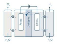
Ilustración 32: Electrolizador alcalino (AEC). [6]
