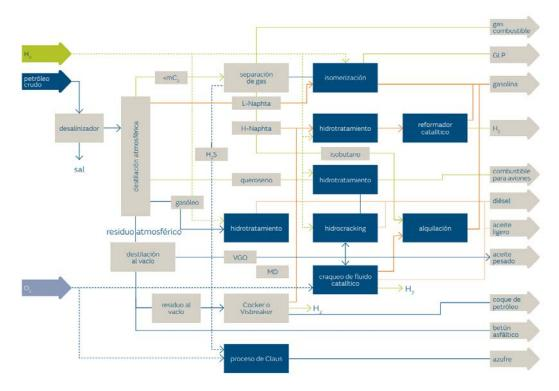
Ilustración 25: Balance de planta de una refinería donde se consume y produce hidrógeno. [6]
