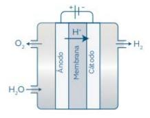
Ilustración 33: Electrolizados de membrana de intercambio de protones (PEM). [6]
