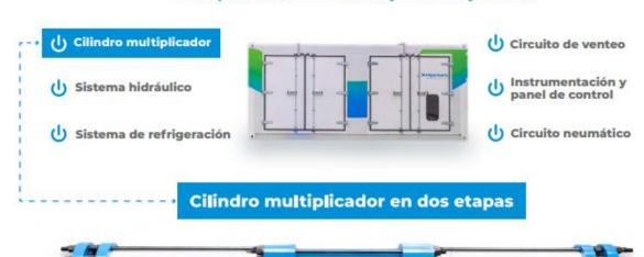
El componente más importante del grupo compresor es el multiplicador o multiplicadores de alta presión, con distintas secciones para llevar a cabo la compresión.
