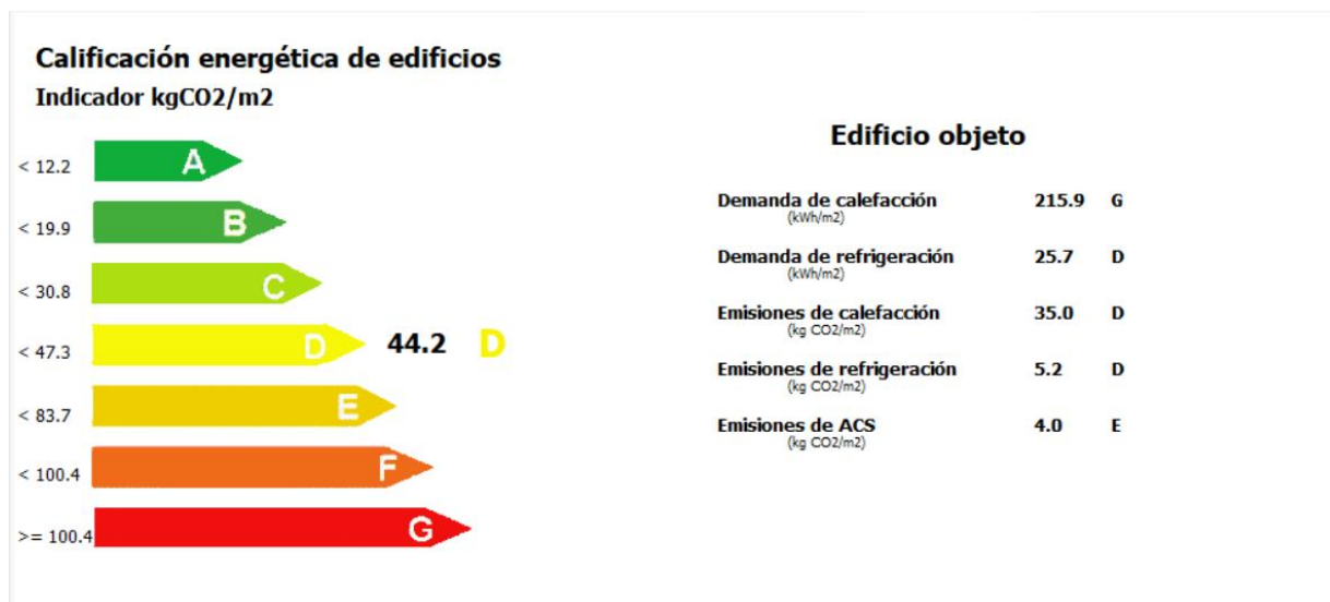
Ilustración 35. Calificación con captadores y bomba de calor
