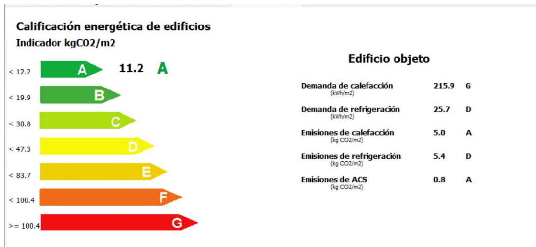
Ilustración 30. Calificación con caldera de biomasa
