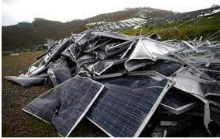
Ilustración 37: Estado de módulos desmantelados
