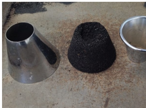
Fig.64: Árido sin desmoronar (Paso 5)
