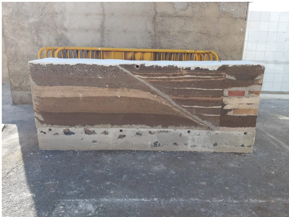
Fig. 1: Tapial realizado en julio de 2022 a escala 1:1 con tierras de Tenerife y ceniza del Volcán Cubre Vieja de La Palma
