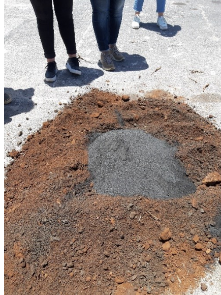
Fig.114: Tierra de El Tornero, grava de 20 mm, árido del Volcán Cumbre Vieja y cal hidráulica
