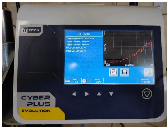
Fig.84: Detalle del lector de deformación
