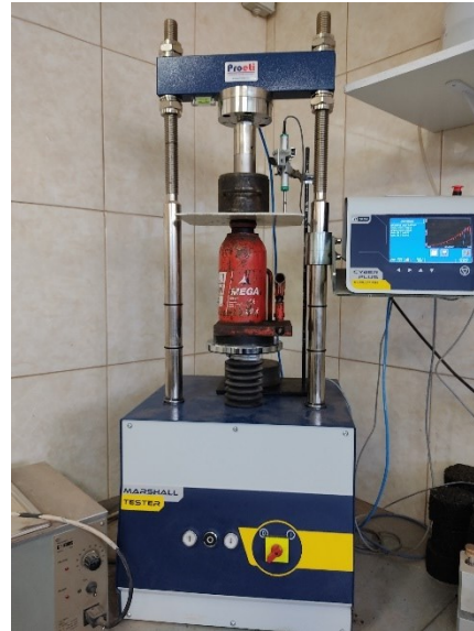
Fig.82: Máquina de compresión 50 kN uniaxial
