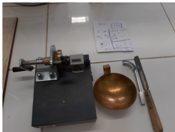
Fig.50: Aparato de Casagrande y acanalador
