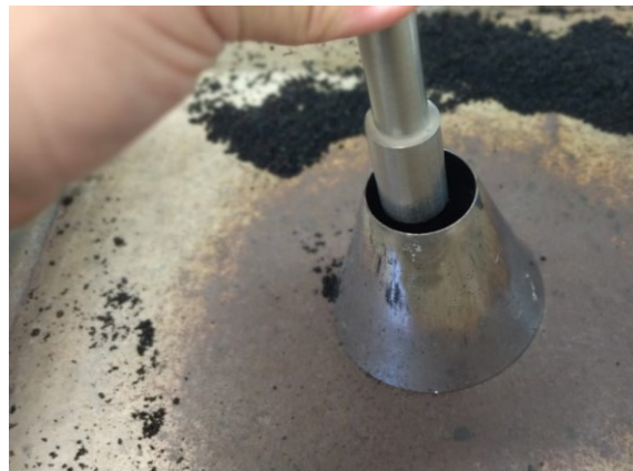
Fig.63: Cono, pisón y árido (Paso 4)
