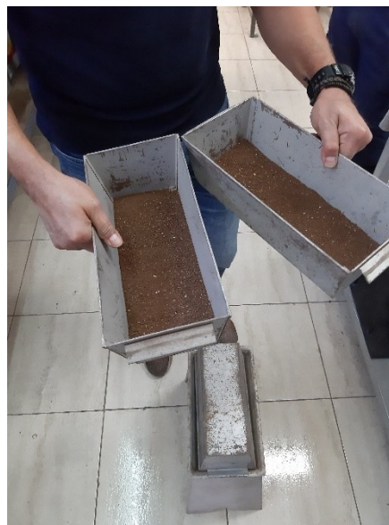
Fig.37: Operación de cuarteo (paso 2)
