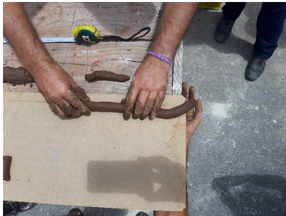
Fig.112: Ejecución del cilindro (paso2)
