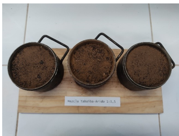
Fig.81: Tierras de Tabaiba con árido de las cenizas del Volcán con dosificación 1:1,5
