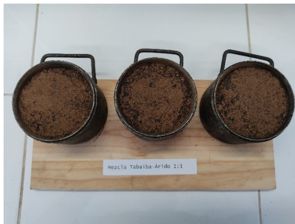
Fig.80: Tierras de Tabaiba con árido de las cenizas del Volcán con dosificación 1:1
