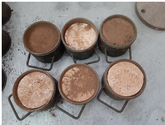
Fig.74: Serie de probetas de prueba con 20 impactos
