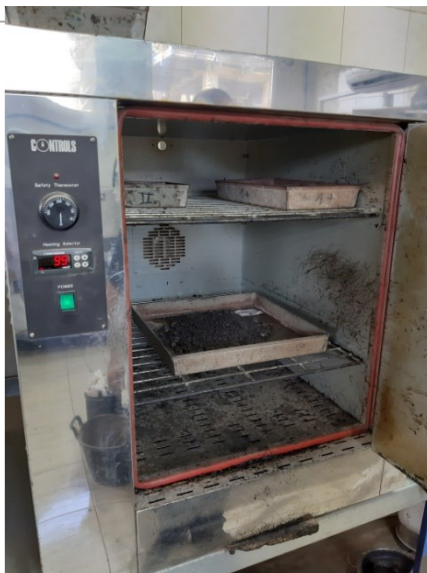
Fig.56: Estufa con muestras a secar
