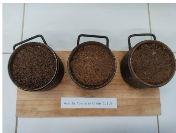
Fig.78: Tierras de La Laguna con árido de las cenizas del Volcán con dosificación 1:1,5
