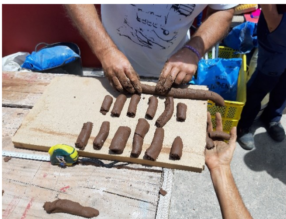
Fig.113: Comprobación del grado de resquebrajamiento del cilindro (paso 3)
