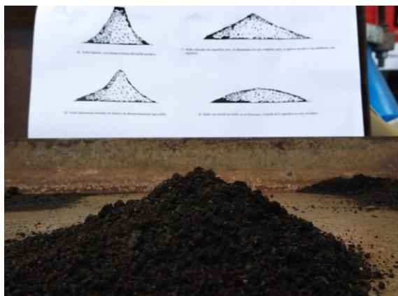
Fig.65: Árido desmoronado (Paso 6)
