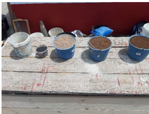
Fig.110: Cal hidráulica NHL5, ceniza del Volcán, tierra de Tabaiba y Tierra de Tórnero
