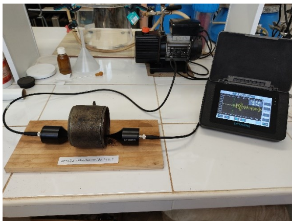
Fig.103: Equipo de ultrasonidos con transductores troncocónicos de 54 kHz
