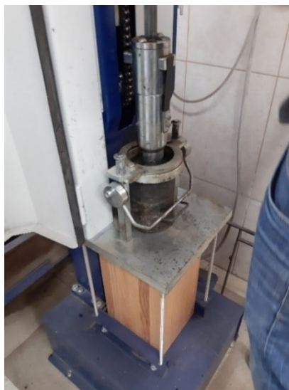
Fig.72: Compactador con probeta
