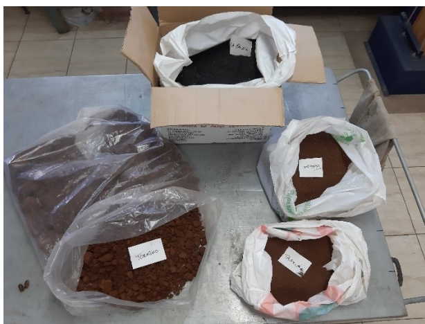
Fig.35: Muestras: tierras de camino El Tornero, Tabaiba y áridos de cenizas de La Palma
