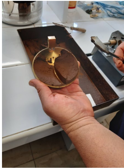
Fig.49: Surco y acanalizador en cuchara de Casagrande.
