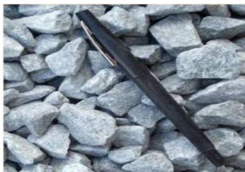
Figura 25. Tamaño del árido utilizado en la capa base drenante.
