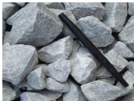
Figura 26. Tamaño del árido utilizado en la capa subbase drenante.
