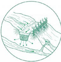
03. Zanjas de infiltración (amunas andinas)
