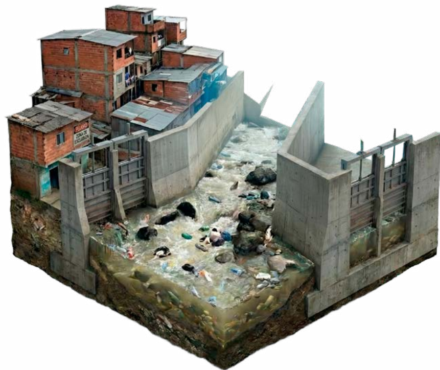
Fig. 06 Isométrico Canalización, contención y exclusión.
