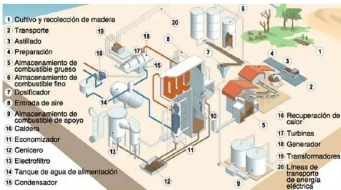
Ilustración 26. Esquema de planta de generación eléctrica a partir de combustión de biomasa.
