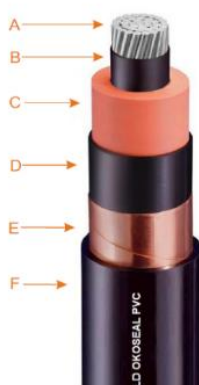
Ilustración 47. Cable por utilizar en la sección de media tensión, modelo Okoguard - Okoseal Type MV-105. Tomado de [61]
