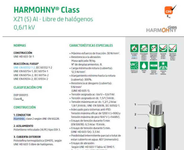
Ilustración 39. Ficha técnica de cableado Harmony. Tomado de [51]
