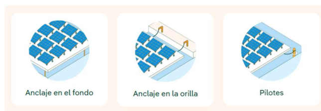
Ilustración 4: Diferentes anclajes para las estructuras flotantes de instalaciones fotovoltaicas. (Fuente: Iberdrola).
