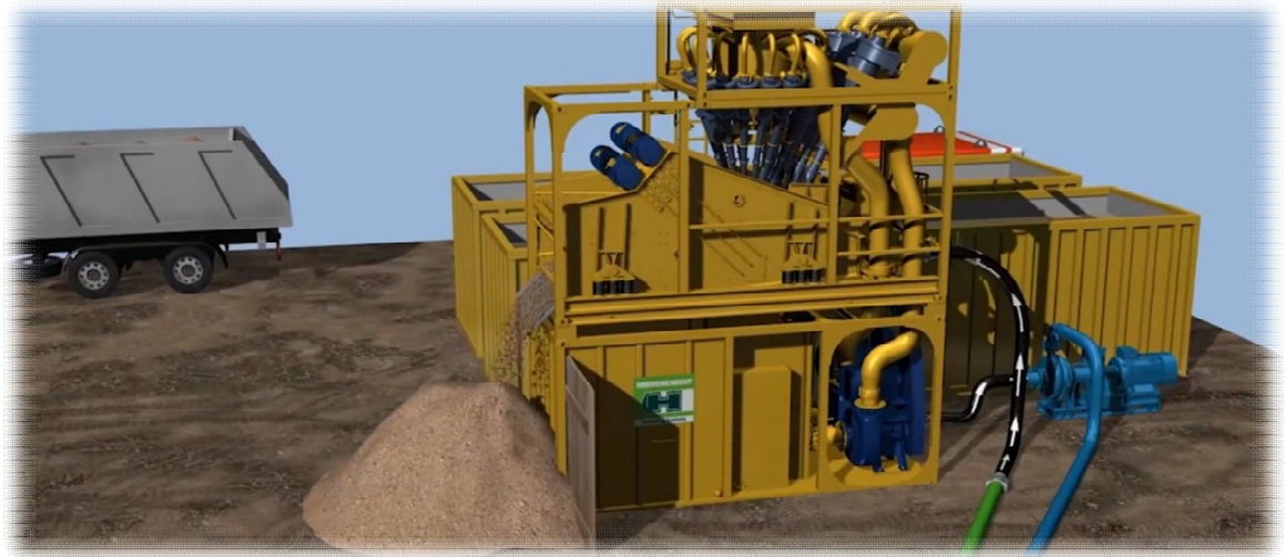
Figura 45. Estación de separación de sólidos con ciclones. Herrenknecht 2025.
