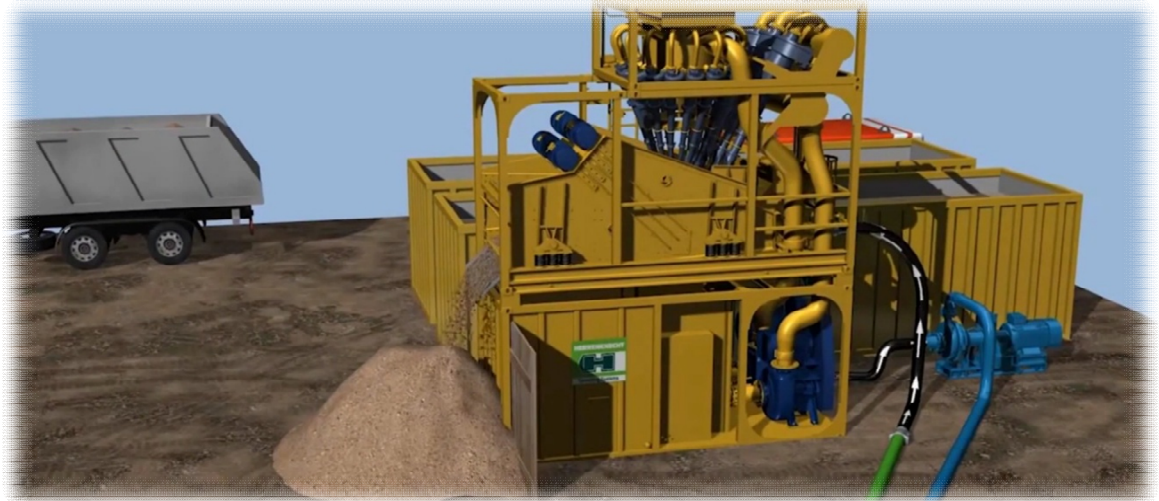
Figura 35. Estación de separación de sólidos con ciclones. Herrenknecht 2025.
