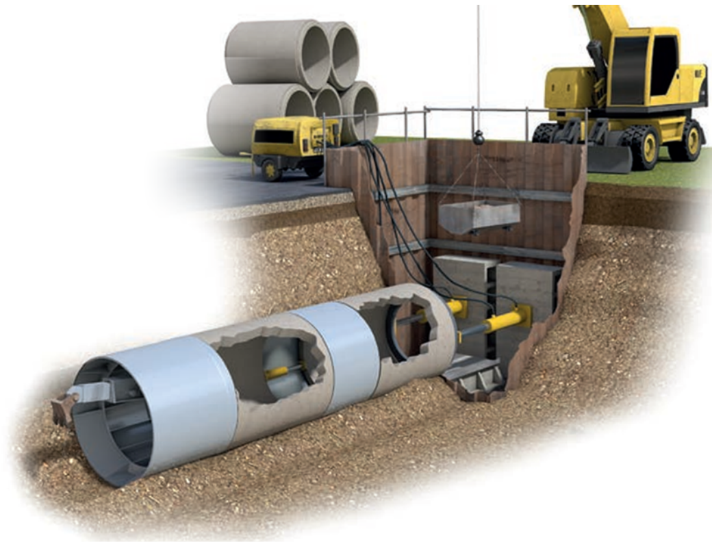
Figura 9. Ejemplo de escudo abierto. Pipe Jacking Association.2017.
