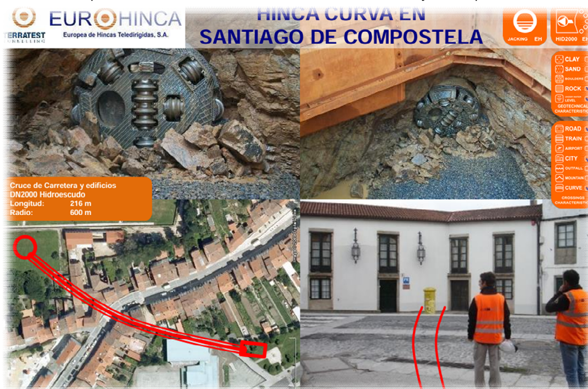
Figura 113. Caso práctico. Microtunelación Santiago de Compostela. Cruce con edificaciones y vial existente. Eurohinca. Asimismo, la presencia de redes de servicios urbanos —como conducciones de agua, saneamiento, gas o telecomunicaciones— introduce condicionantes adicionales. Estos elementos suelen
