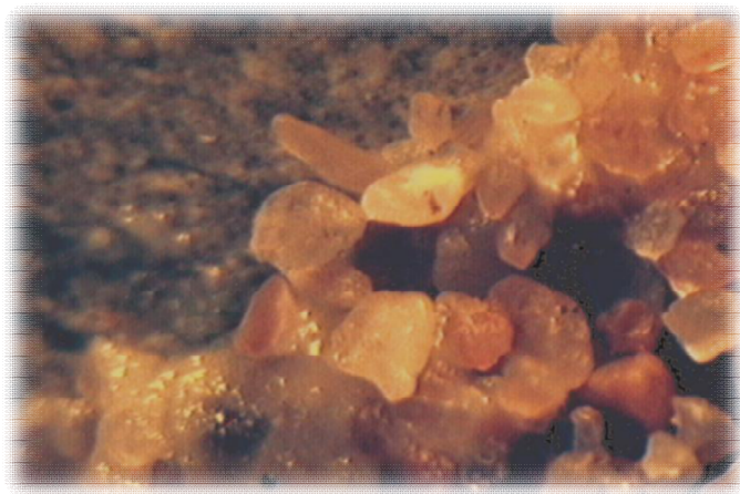
Figura 39. Vista de la interacción bentonita-tubería de hormigón. Namli & Guler, 2017
