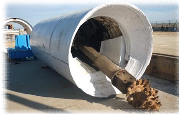
Figura 14. Escudo abierto con cabezal tipo rozadera. Eurohinca.
