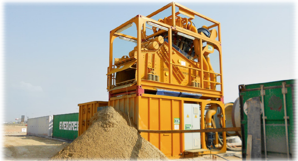
Figura 110. Acopio de lodos tras pasar por separador compacto. Herrenknecht 2025.
