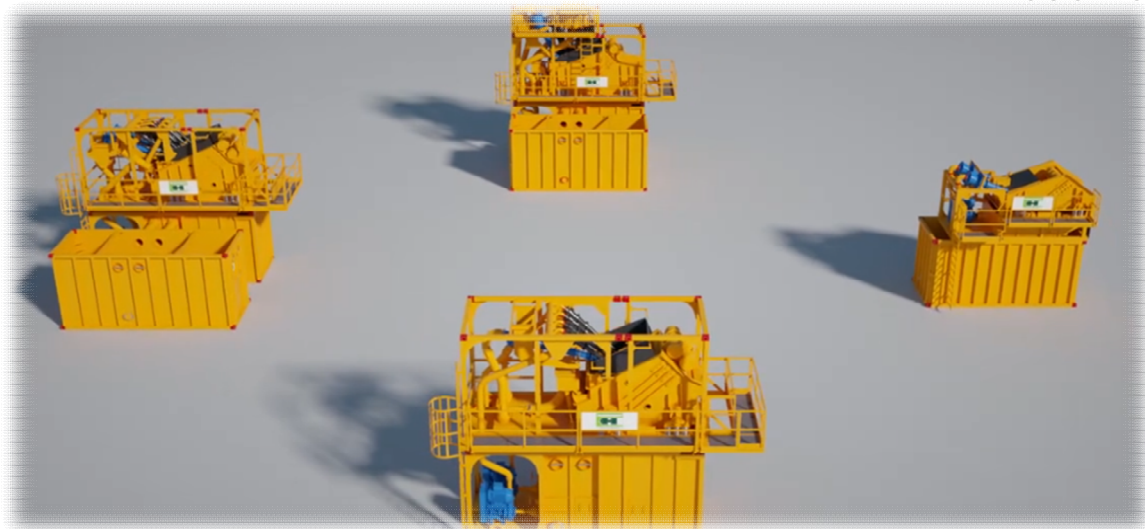
Figura 109. Diferentes composiciones para los elementos de separación primaria. Herrenknecht 2025.
