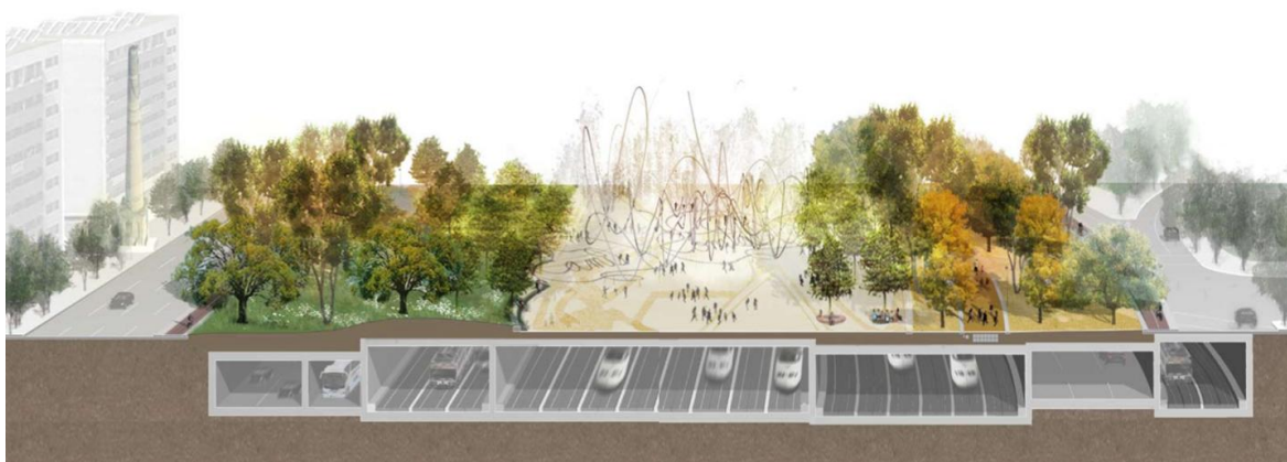
Figura 3-33. Infografía de una integración completa incluyendo ferrocarril y tráfico rodado. (Fuente: Adif)
