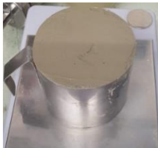
Figura 7: taza de medición de densidad en fresco, con el mortero en su interior y enrasado. Imagen propia.
