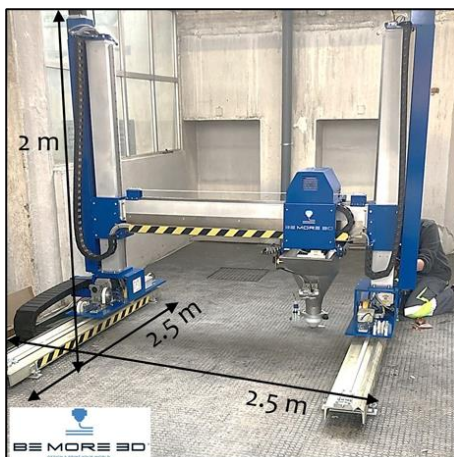
Figura 12: Impresora 3D donde se llevó a cabo el escalado semi-industrial. Imagen propia.
