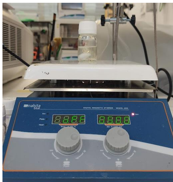
Figura 2: Frasco con disolución de PLGA/PCL sobre agitador magnético en proceso de disolución.
