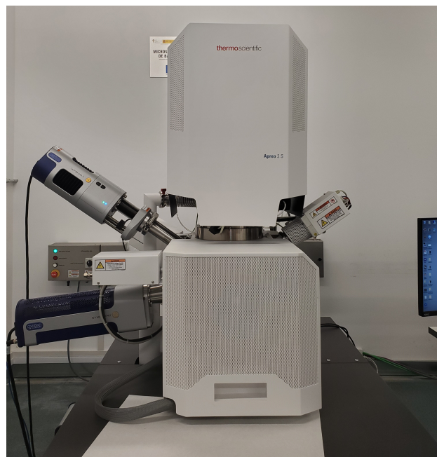
Figura 12: Imagen del microscopio SEM Apreo 2S LoVac.
