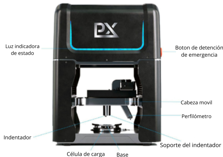
Figura 2: Plastómetro PLX-benchtop y las partes que lo componen. Imagen tomada de Clyne et al., 2021.
