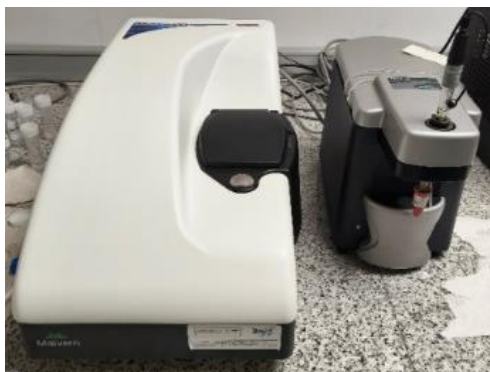
Figura 16: Zetaziser Nano ZS operado a longitud de onda roja de 632,8 nm de la casa comercial Malvern
