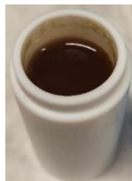
Figura 9: Disolución de tono marrón obtenida tras el tratamiento hidrotermal en autoclave a 160°C durante 5 horas.
