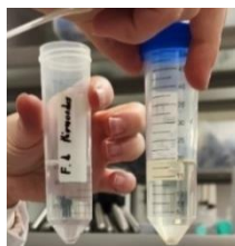
Figura 11: Comparación de las disoluciones tras la primera centrifugación de los tratamientos por microondas con agitación (a la izquierda) y sin agitación (a la derecha).
