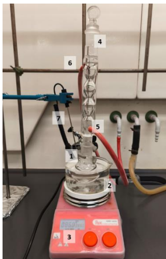
Figura 10: Montaje de reflujo empleado en la síntesis mediante el protocolo 2 con el balón de destilación (1), un baño de silicona (2), el agitador magnético con calefacción (3), la columna de reflujo (4) con la boquilla inferior (5) y boquilla superior (6), y el termopar (7).
