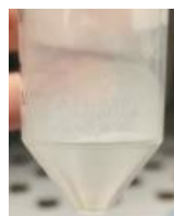
Figura 12: Deposición de la muestra P2R en la superficie del tubo Falcon tras el secado.
