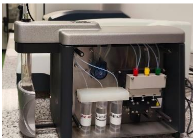
Figura 17: Disposición del equipo de titración con la muestra a la izquierda de la imagen, y el ácido fuerte (rojo), la base media (amarillo); y la base fuerte (verde) colocadas en sus posiciones.
