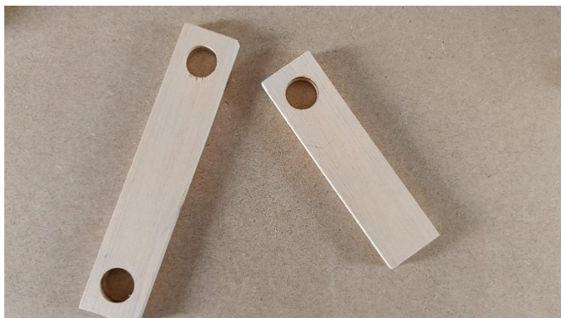
Figura 14 Eslabones 1 y 2 de longitudes 20 y 15 cm respectivamente y ancho de 4 cm con agujeros de 8 mm de diámetro
