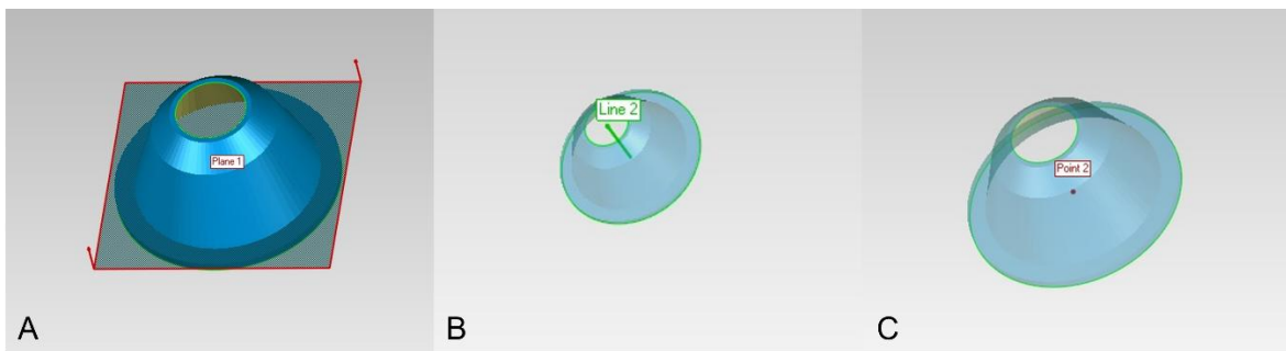
Figura 8. Procedimiento de definición geométrica de cada marcador en el software Geomagic Control X. A. Generación del plano de referencia tangente a la superficie superior del marcador. B. Trazado de la línea axial correspondiente al eje longitudinal del marcador. C. Determinación del punto de referencia central sobre la base del marcador para la obtención de coordenadas tridimensionales.
