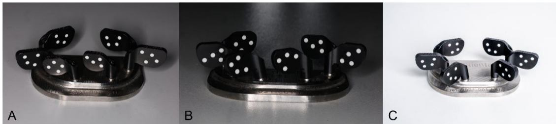
Figura 1. Modelo mecanizado de titanio con seis pilares MU diseñado para la conexión directa de PIC transfers. A. Modelo con PIC transfers combinados (mini y estándar) B. Modelo con PIC transfers mini. C. Modelo con PIC transfers estándar.
