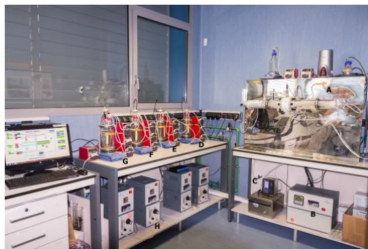
Figura 1. Imagen del simgi® (CIAL-CSIC) y la disposición de sus distintos componentes y reactores. Estómago (A), bomba de flujo (B), baño de agua (C), intestino delgado (D), colon ascendente (E), colon transverso (F), colon descendente (G) y las cajas de los controladores de pH, temperatura y nitrógeno (H). Figura tomada de Cueva et al., 2019 (46).
