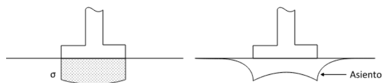
Figura 3-28 – Tensión-Asiento en cimentación flexible en suelo granular
