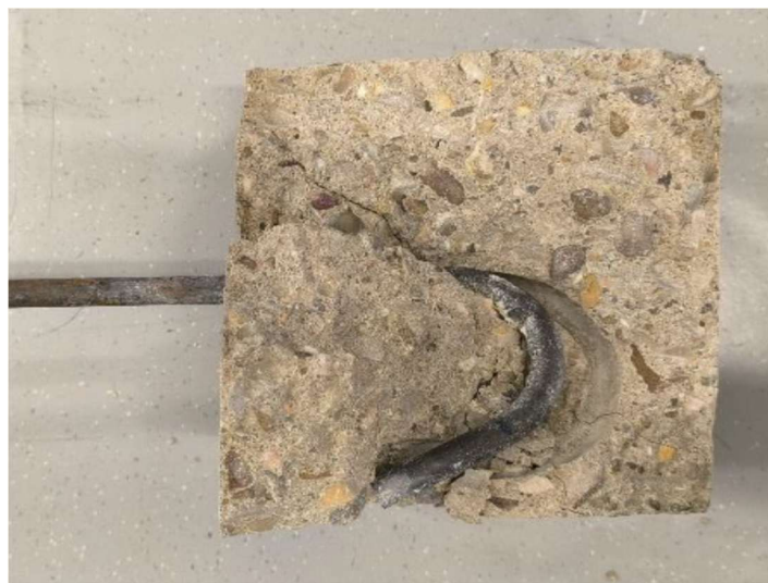
Ilustración 46 - Aspecto interior del bloque de hormigón 1 tras ensayo (INTEMAC)
