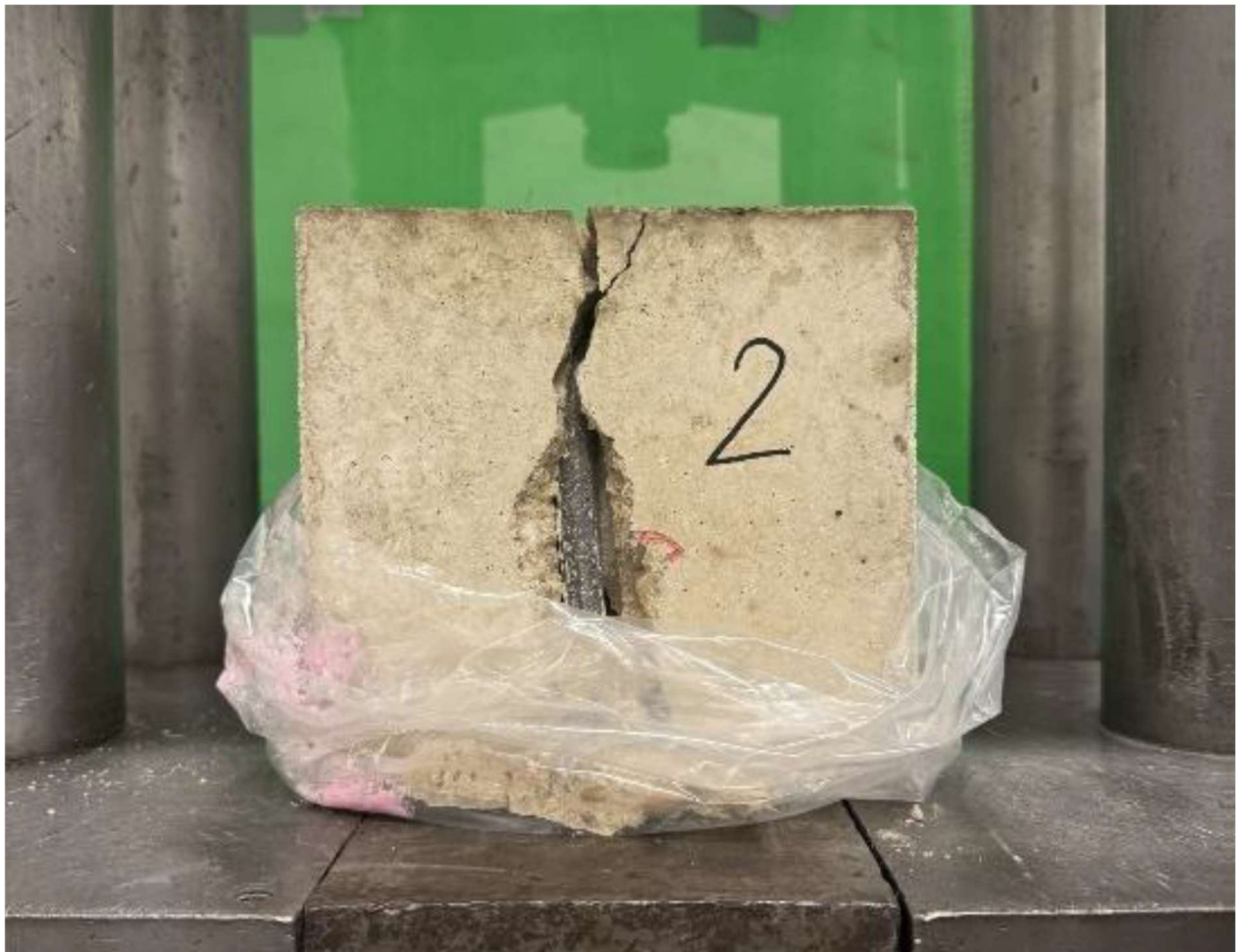
Ilustración 47 - Aspecto general del bloque de hormigón 2 tras ensayo (INTEMAC)
