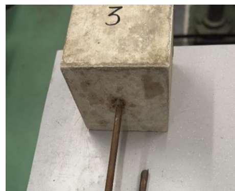
Fotografía 7. Aspecto interior del bloque de hormigón 3 tras ensayo
