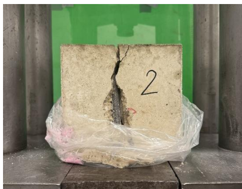
Fotografía 4. Aspecto general del bloque de hormigón 2 tras ensayo
