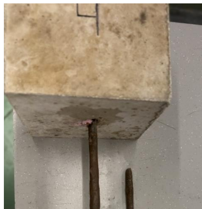
Fotografía 9. Aspecto interior del bloque de hormigón 4 tras ensayo
