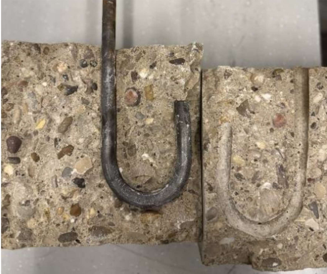
Ilustración 48 - Aspecto interior del bloque de hormigón 2 tras ensayo (INTEMAC)
