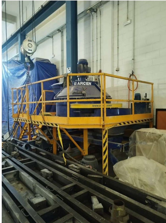
Ilustración 43 - Amasadora Vertical tipo ARCEN (INTEMAC)
