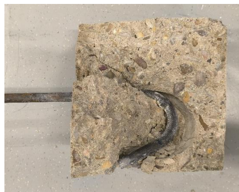
Fotografía 3. Aspecto interior del bloque de hormigón 1 tras ensayo
