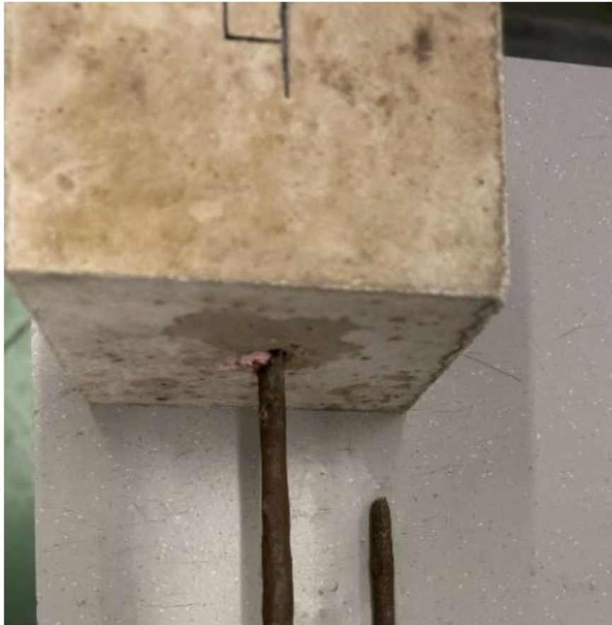
Ilustración 52 - Aspecto interior del bloque de hormigón 4 tras ensayo (INTEMAC)
