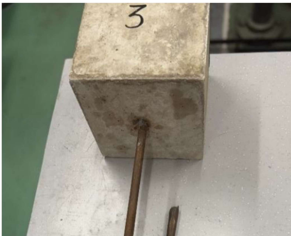
Ilustración 50 - Aspecto interior del bloque de hormigón 3 tras ensayo (INTEMAC)
