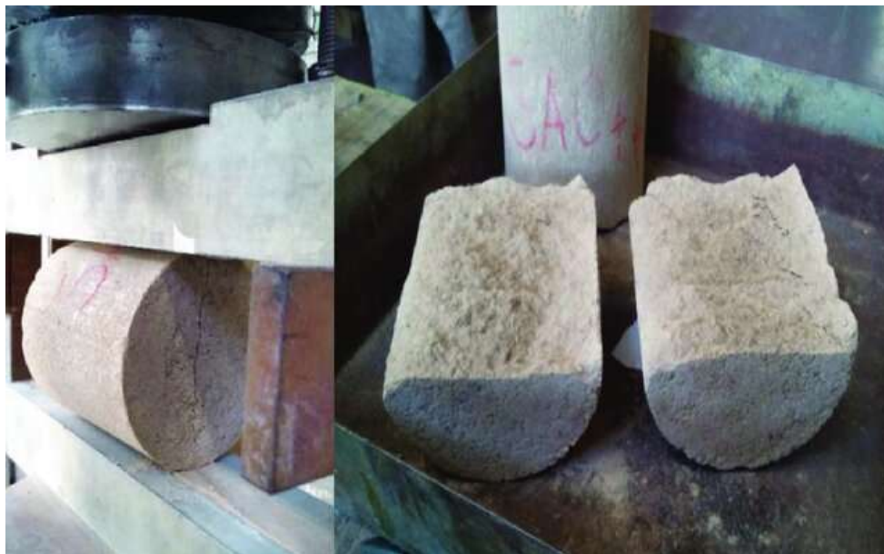
Ilustración 38 - Estado visual de la probeta posterior al ensayo de tracción indirecta (Efecto de la Incorporación de Pequeñas Dosis de Emulsión Asfáltica en el Comportamiento de Estabilizaciones de Suelo con Cemento Portland, 2020)
