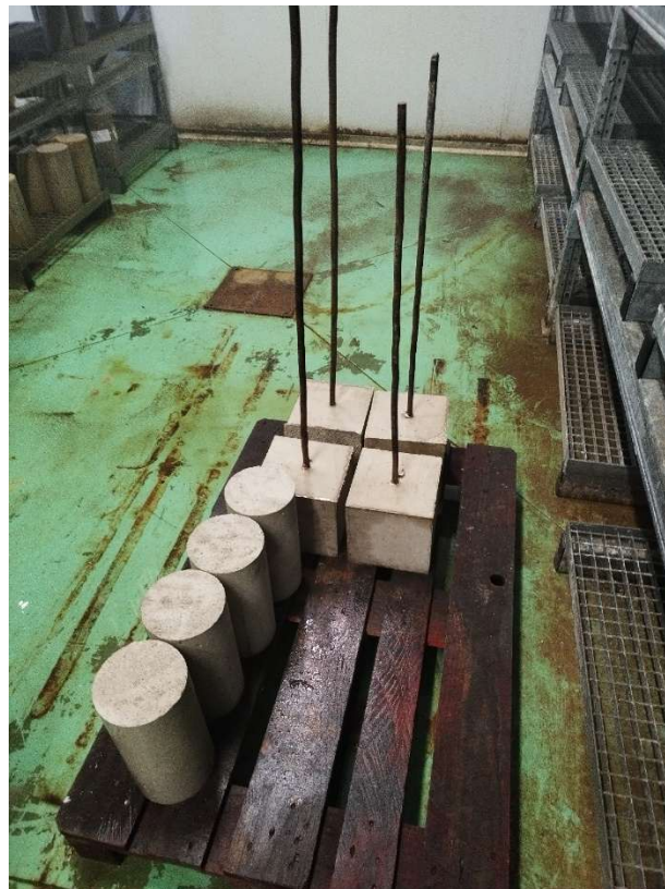
Ilustración 41 - Probetas cilíndricas y cúbicas para el ensayo (INTEMAC)
