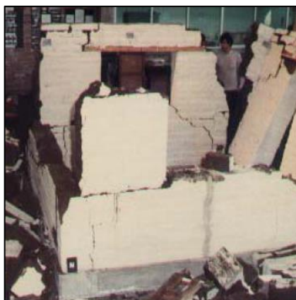
Figura 58. Ensayo de laboratorio de una vivienda de adobe evaluando su comportamiento sísmico sin reforzar (izquierda). Ensayo de laboratorio de una vivienda de adobe evaluando su comportamiento sísmico con refuerzo interior de cañas y viga collar (Derecha).
