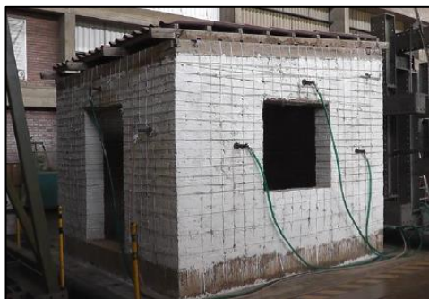
Figura 51. Dispositivos de medición LDVT ubicados en la estructura colocada sobre la mesa vibratoria. Fuente: Análisis dinámico no lineal de un modelo de vivienda de adobe reforzado con sogas, Leceta R. et al. (2020).
