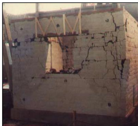
Figura 58. Ensayo de laboratorio de una vivienda de adobe evaluando su comportamiento sísmico sin reforzar (izquierda). Ensayo de laboratorio de una vivienda de adobe evaluando su comportamiento sísmico con refuerzo interior de cañas y viga collar (Derecha).
