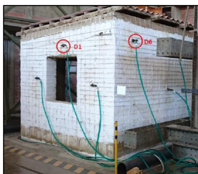
Figura 52. Puntos de medición que arrojaron los valores máximos de en cuanto a fuerzas y desplazamientos registrados, y resultado de los daños en la vivienda tras la simulación. Fuente: Análisis dinámico no lineal de un modelo de vivienda de adobe reforzado con sogas, Leceta R. et al. (2020).
