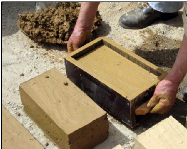
Figura 14. Fabricación tradicional de las piezas de mampostería de adobe. Fuente: Construcción con tierra: Reinterpretación de una tradición (Catalán., 2018).
