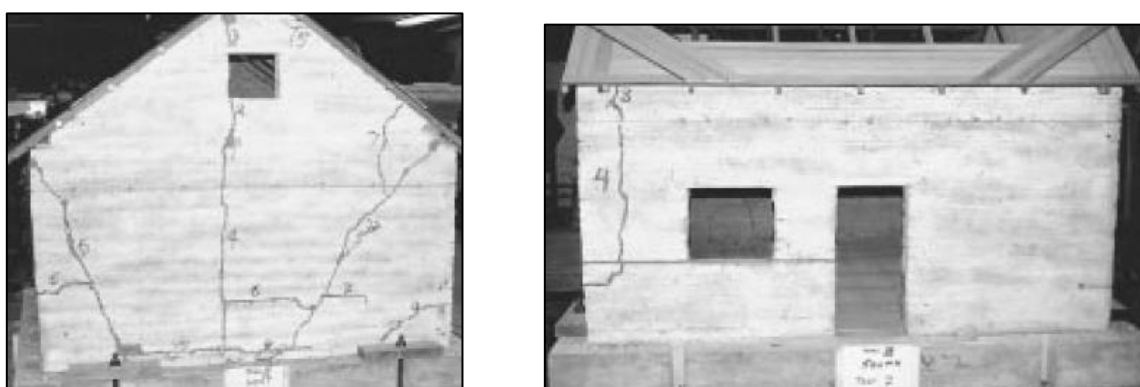
Figura 81. Resultado estructural de la vivienda con reforzamiento de correas y varillas de fibra de vidrio expuesta ante el nivel de prueba VIII (EPGA = 0.48).
