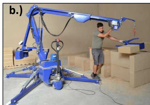
Figura 21. (a.) Montacargas para manipulación de bloques prefabricados de gran formato. (b.) Grúa especializada para manipulación de bloques prefabricados de mediano – pequeño formato.
