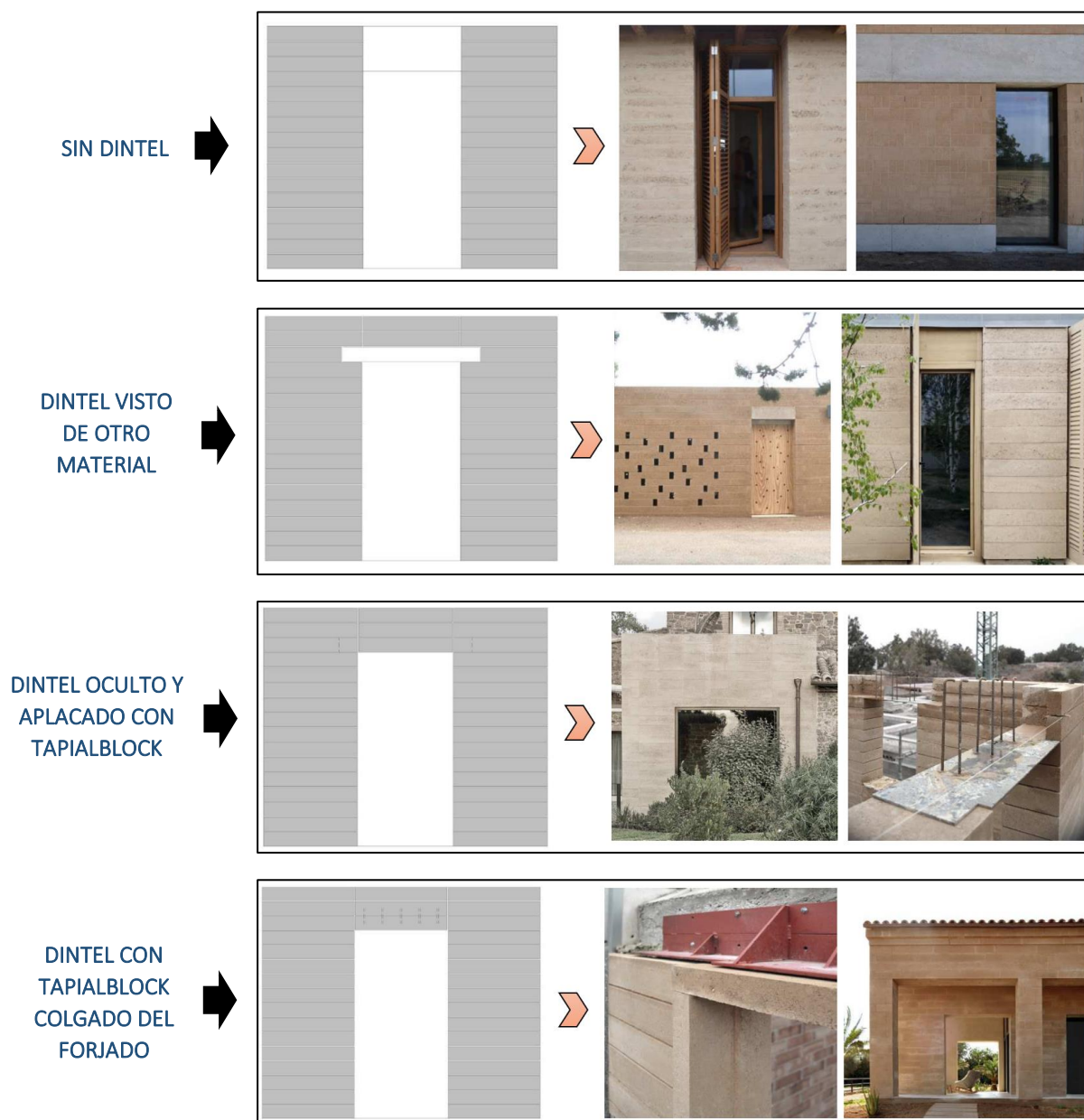
Figura 24. Diferentes tipos de dinteles que se pueden considerar para el Tapialblock. Fuente: FETDETERRA – Guía para la ejecución de muros de tierra con bloques prefabricados Tapialblock.
