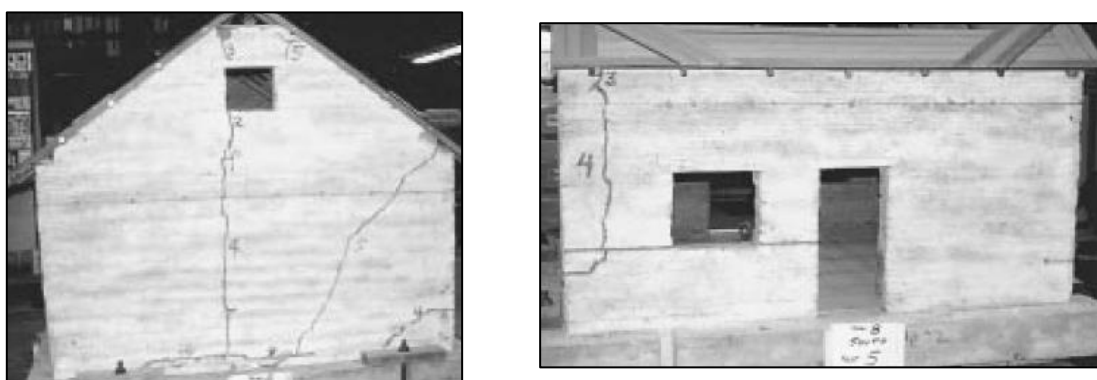
Figura 79. Resultado estructural de la vivienda con reforzamiento de correas y varillas de fibra de vidrio expuesta ante el nivel de prueba VI (EPGA = 0.40).
