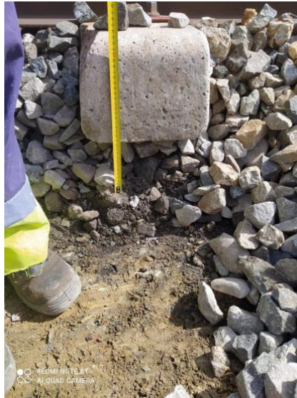
Imagen 29. Cata hilo alto para clasificación de balasto, balasto bajo traviesa y calidad de explanada.
