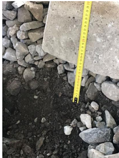
Imagen 30. Cata hilo bajo para clasificación de balasto, balasto bajo traviesa y calidad de explanada.
