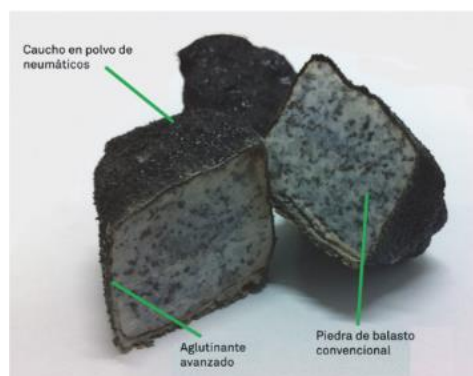
Imagen 16. Piedra de balasto ferroviario con recubrimiento de caucho de polvo de NFU (Royes et al., 2022).
