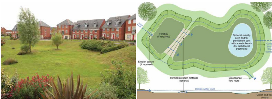
Figura 10. Vista general, planta y alzado de depósitos de detención superficiales abiertos vegetados ( Detention basins ) (Fuente: 19, p. 473 y 474).
