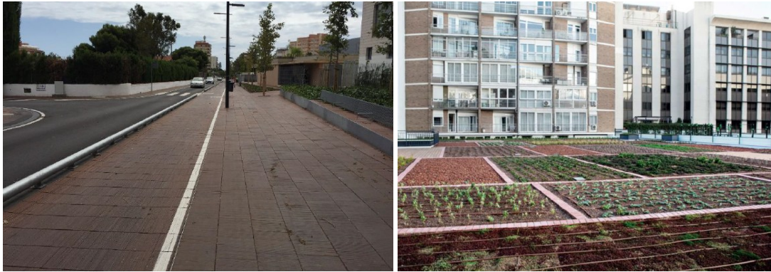
Figura 4. Izquierda: Pavimento permeable en Benicàssim (Castellón). Derecha: Cubierta vegetada sobre un supermercado en Madrid (Fuente: 6, p. 67 y 69).
