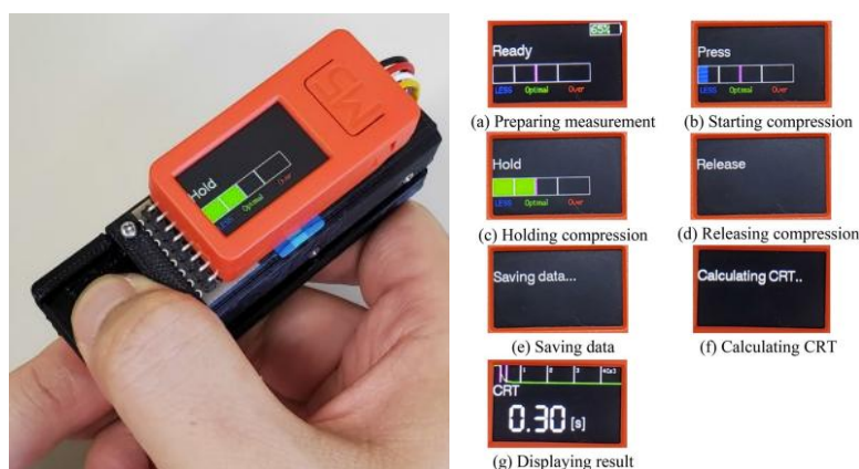
Figura 5: Dispositivo portátil para la medición automática del TRC y secuencia de visualización en pantalla durante el proceso de medición. (22)
