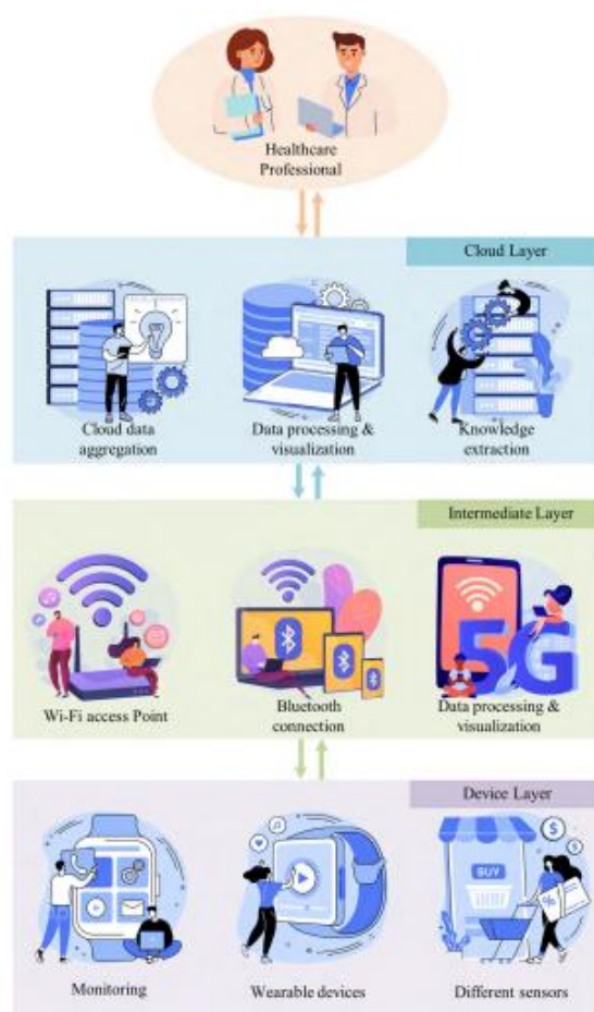
Figura 21: Arquitectura por capas de un sistema IoMT–Big Data que integra sensorización, comunicación y análisis clínico en la nube. (36)
