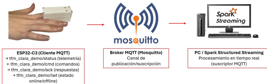
Figura 22: Esquema de la infraestructura de comunicación IoT mediante protocolo MQTT entre el dispositivo ESP32-C3, el broker Mosquitto y el sistema de procesamiento en tiempo real. Fuente: elaboración propia.
