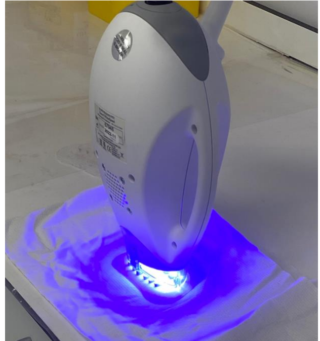
Imagen 11 : Activación en curso sobre las muestras del Grupo A con la lámpara Zoom! Advanced Power
