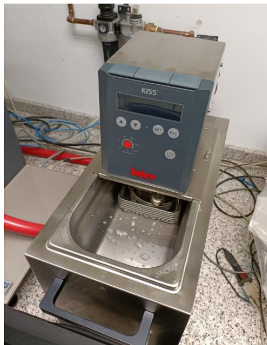
Fig.12 Baño de silicona como refrigerante.
