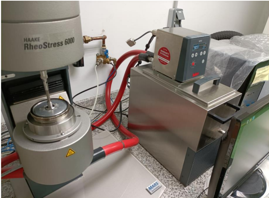
Fig9. Equipo de análisis reológico ThermoSpecific RheoStress6000 y termostato HUBER KISS K6
