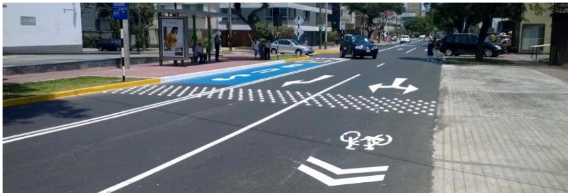
Figura 14. Demarcación de carril compartido con Sharrow, Lima. Fuente: Jessica Tantalean.
