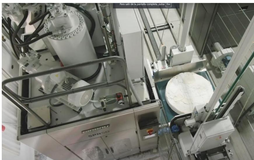
Nota: Vista de cómo se traslada la ropa compacta de la prensa al secador por el elevador. Tomado de Girbau.(Girbau Laundry Equipment, 2024)
