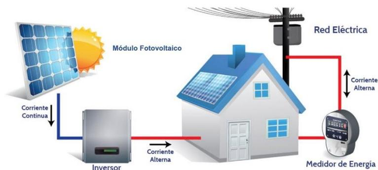
*Ilustración 2: Esquema sistema fotovoltaico on-grid (Fuente: Ilumin Online)*
