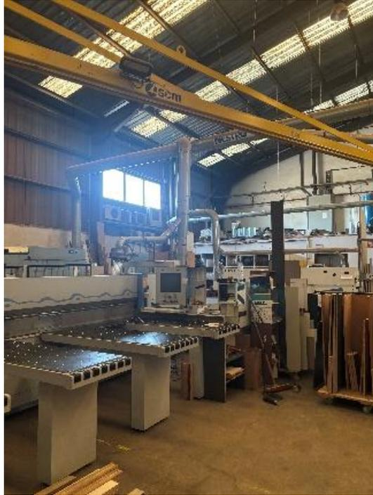
*Figure 7. Seccionadora. Fuente: Propia(2025)*
