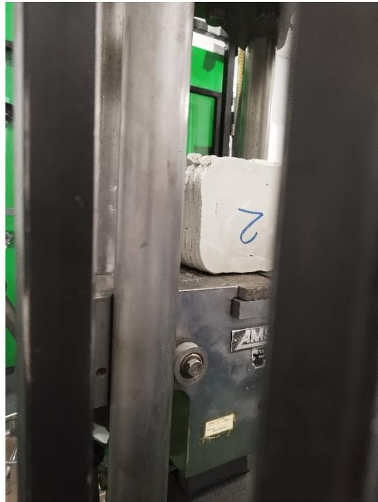
*Ilustración 42. Ensayo de anclaje de la Probeta 2*
