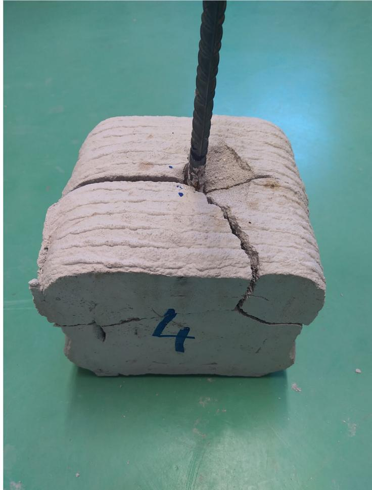
ENSAYOS DE ARRANCAMIENTO (PULL OUT) DE BARRAS DE ACERO
