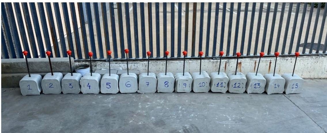
Ilustración 37. Probetas antes de ensayo de adherencia
