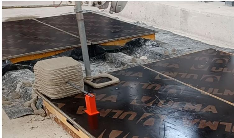
Ilustración 29. Comienzo de impresión de una probeta
