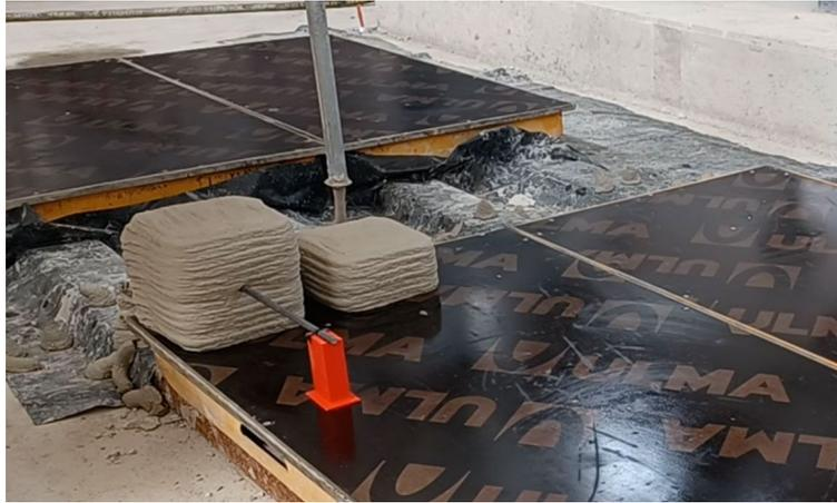
*Ilustración 30. Fase 1 de hormigonado de probetas*
