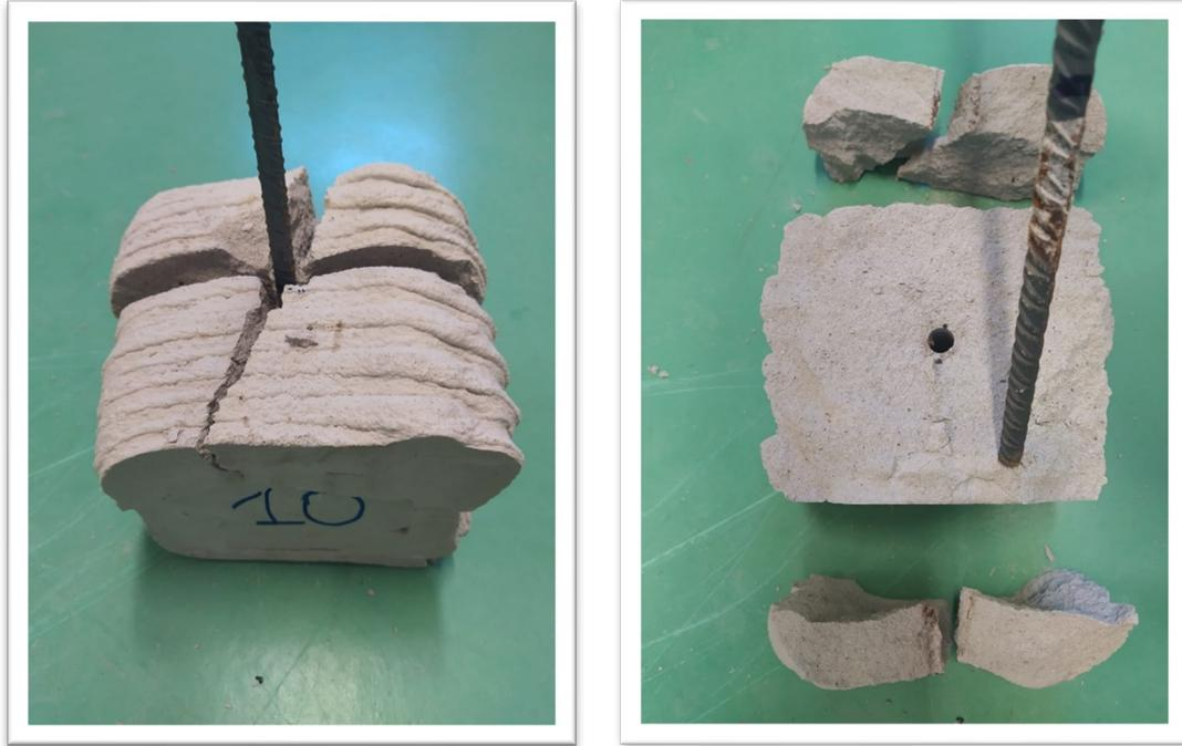
Ilustración 72. Probeta N.º 10. Forma de rotura
