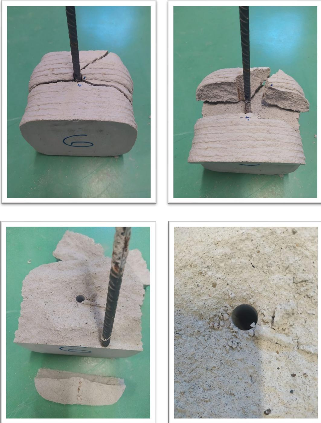
*Ilustración 68. Probeta N.º 6. Forma de rotura*
