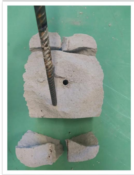
*Ilustración 71. Probeta N.º 9. Forma de rotura*
