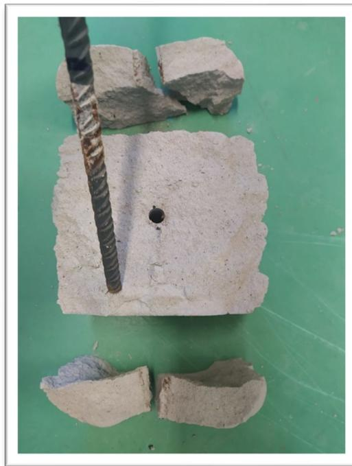
*Ilustración 66. Probeta N.º 4. Forma de rotura*
