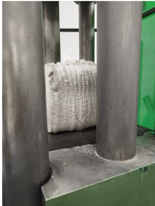
*Ilustración 43. Colapso en ensayo de la Probeta 2*
