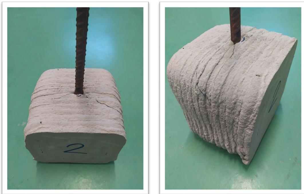
*Ilustración 64. Probeta N.º 2. Forma de rotura*
