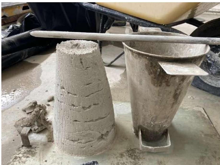
Resultado del ensayo del Cono de Abrams
