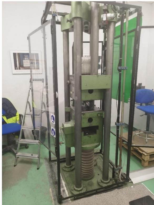
*Ilustración 41. Prensa de tracción del Laboratorio de INTEMAC*
