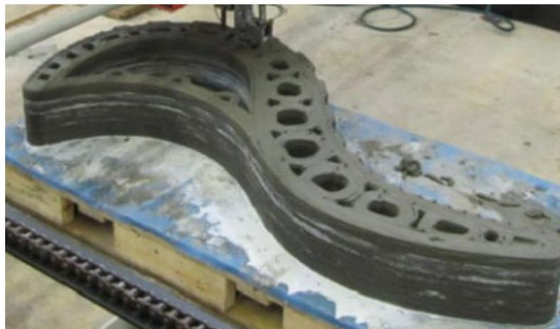
*Ilustración 5. Pieza de hormigón impreso: Obsérvese la nervadura en el lateral (Le, Austin, Lim, Buswell, Gibb, et al., 2012)*
