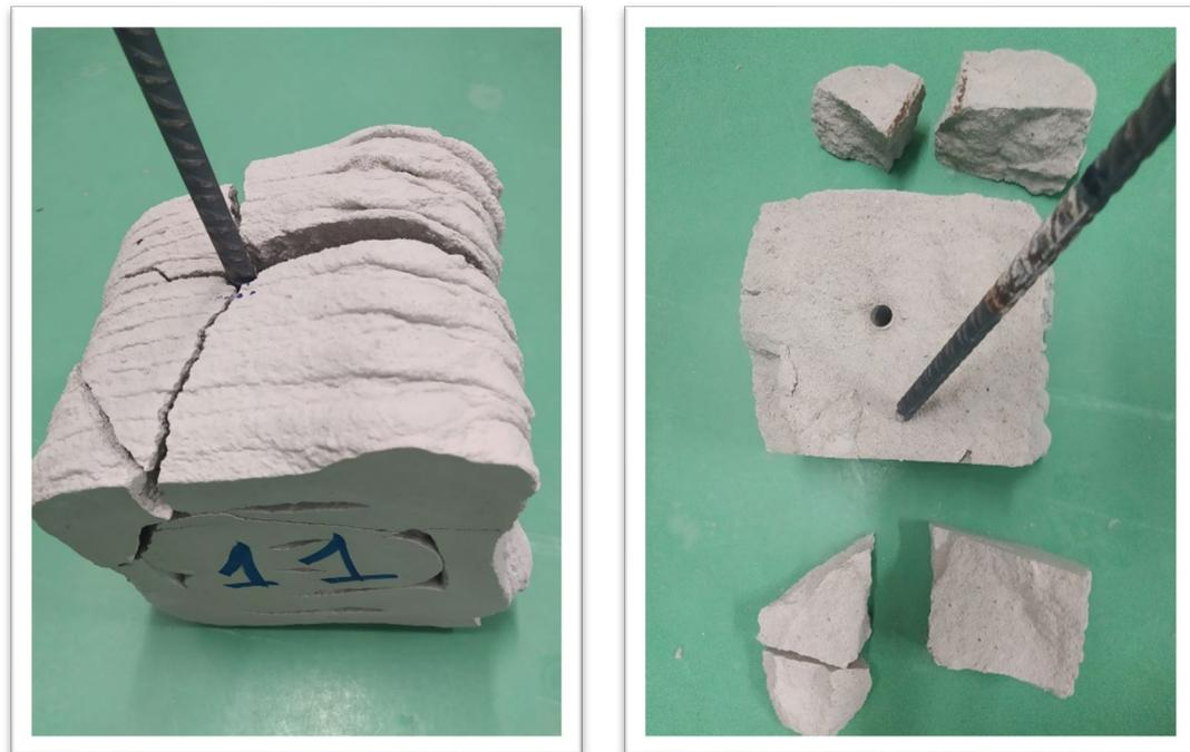
Ilustración 73. Probeta N.º 11. Forma de rotura
