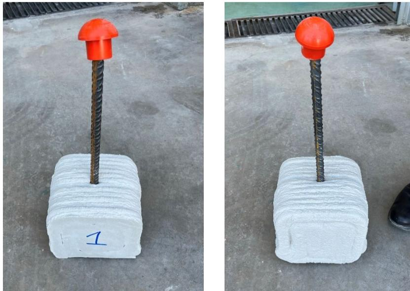
Ilustración 38. Probeta N.º 1 de capas paralelas
