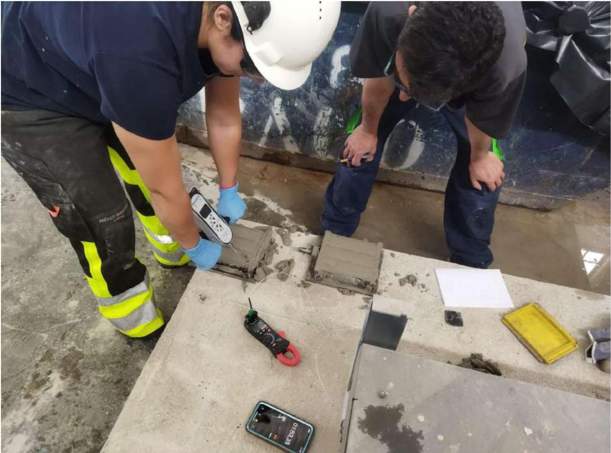
Realización del ensayo de resistencias tempranas
