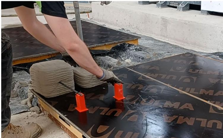
*Ilustración 31. Colocación de la armadura en la probeta*
