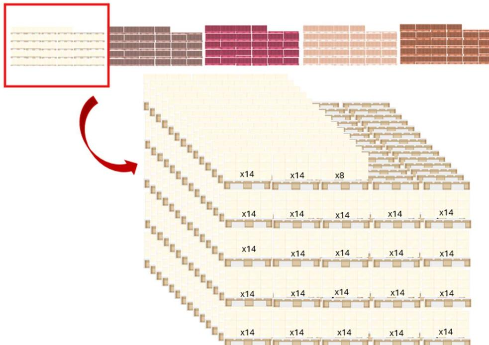
Figura 24. Almacén de PT estado futuro estanterías dinámicas: suelo + 4 alturas (Ubicaciones totales: 1.750, ubicaciones utilizadas: 1.580).
