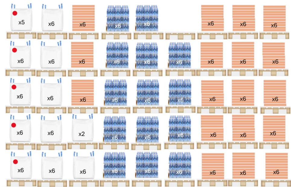
Figura 21. Almacén de MP estado futuro estanterías dinámicas: suelo + 4 alturas (Ubicaciones totales: 270, ubicaciones utilizadas: 259).
