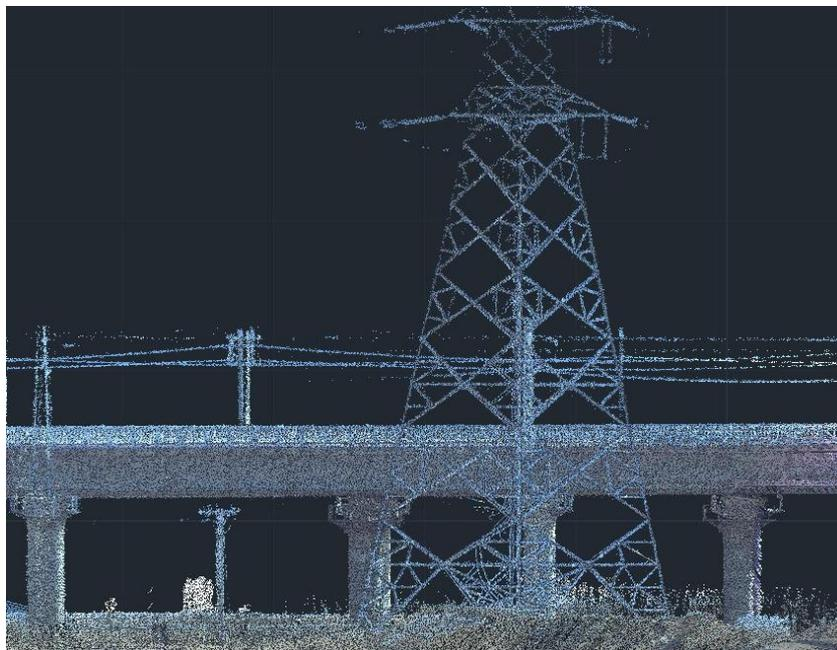
*Ilustración 60. Líneas de alta tensión eléctricas capturadas con Mobile mapping. (Leica Geosystems., 2019)*
