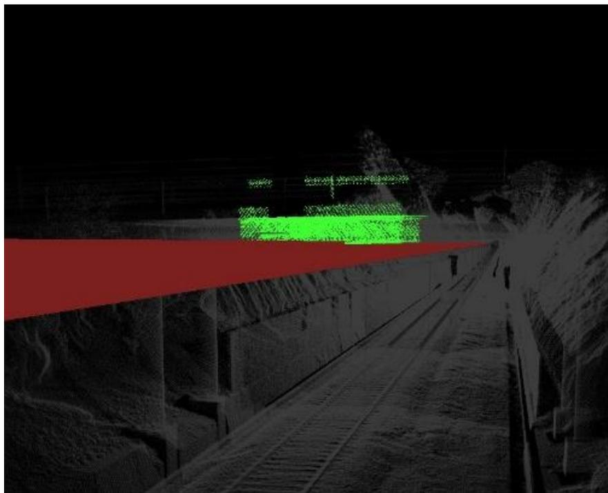
*Ilustración 169. Conflicto detectado en el Informe de colisiones entre el gálibo del pantógrafo del GEC16 y el Paso Superior CV-601. (Elaboración propia)*
