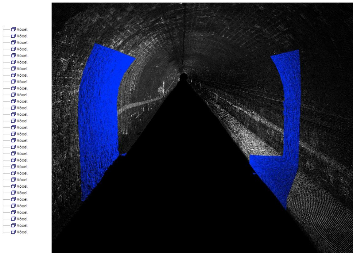
*Ilustración 161. Voxel agrupando puntos en hastial izquierdo y derecho, en túnel de La Anchada. (Elaboración propia)*
