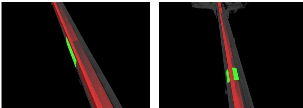
*Ilustración 167. Conflicto detectado en el Informe de colisiones entre el túnel de La Anchada y el gálibo GEC16 junto con el gálibo del pantógrafo. (Elaboración propia)*
