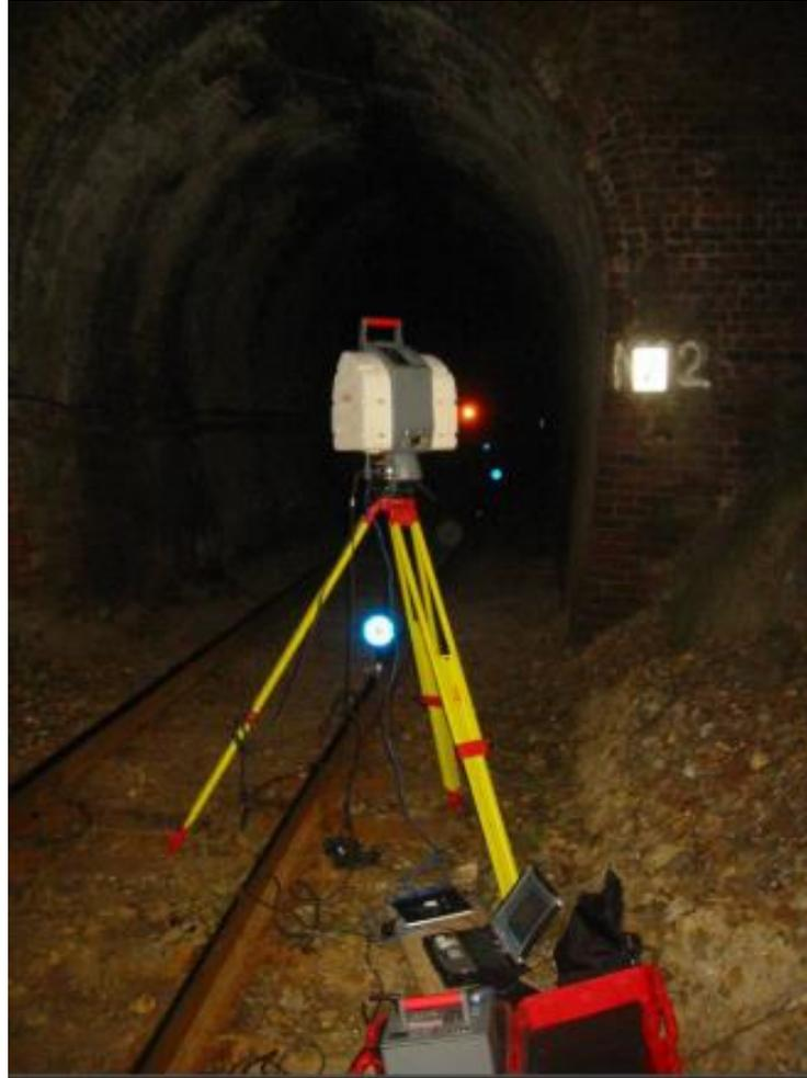
*Ilustración 49. Equipo Terrestrial Laser Scanner (TLS) escaneando un túnel. (Pinkerton, M., 2010)*
