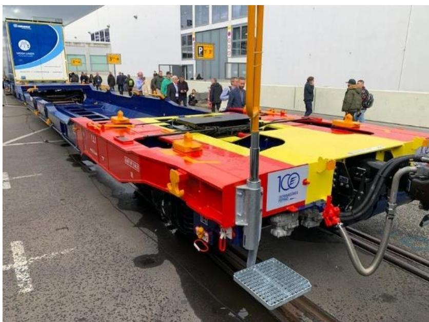
*Ilustración 40. Vagón Pocket T4000 destinado a la autopista ferroviaria, de la empresa VTG. (Tecnología Ferroviaria., 2022)*
