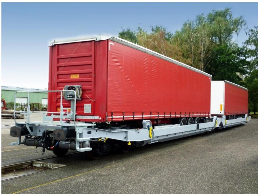
Ilustración 38. Vagón LOHR UIC transportando semirremolques de carretera estándar de 4 m de altura en las principales líneas europeas. (LOHR, 2024)
