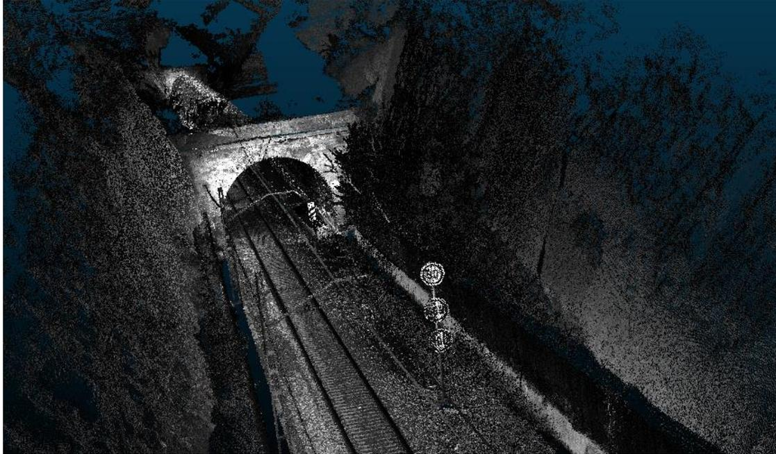
Ilustración 139. Nube de puntos del túnel de “La Anchada” lado Madrid. (Elaboración propia)
