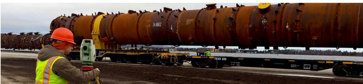
*Ilustración 47. Medición con Estación Total. (Leica Geosystems., 2019)*
