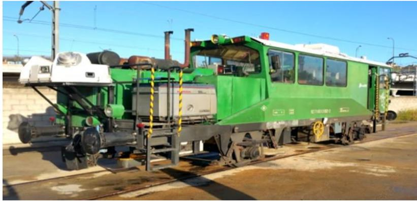
*Ilustración 68. Dresina equipada con sistema mobile mapping. (Ingeniería INSITU., 2017)*
