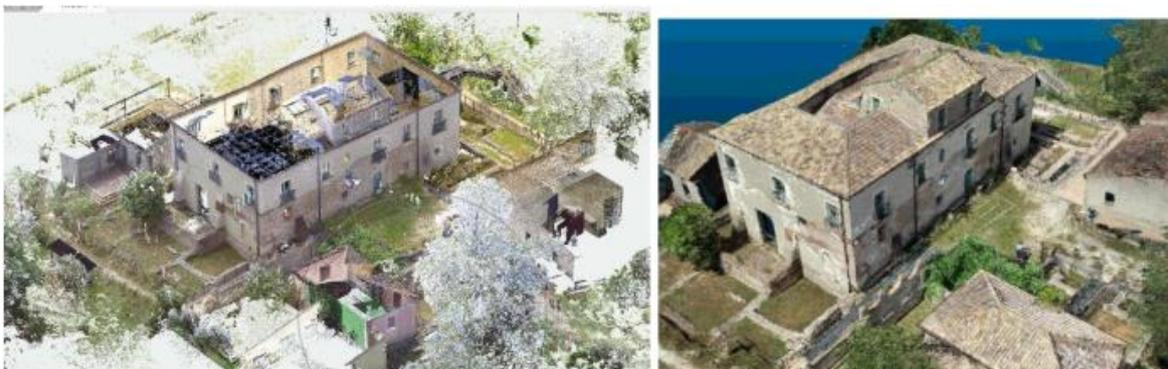
*Ilustración 51. A izquierda la nube de puntos obtenida del levantamiento con Escáner Láser Terrestre y a derecha la nube de puntos obtenida mediante fotografías aérea. (Eugenia Polo García, María & Sánchez Ríos, Alonso, 2022)*
