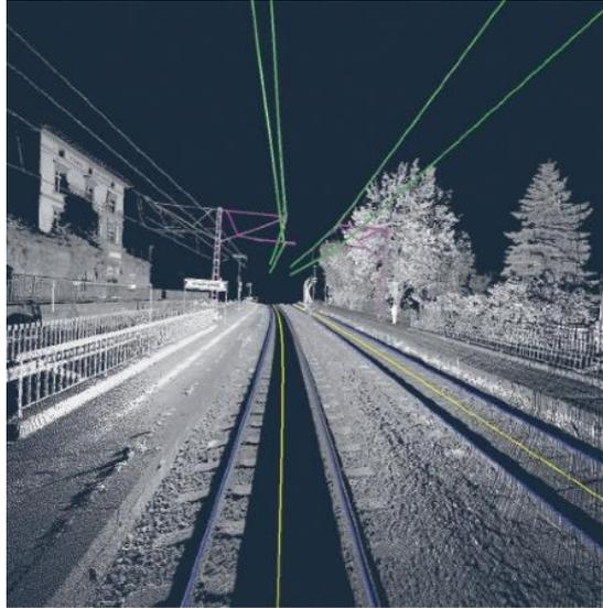
Ilustración 71. Módulo SiRailScan identificando carriles, entreje y LAC en una nube de puntos. (Leica Geosystems., 2019)
