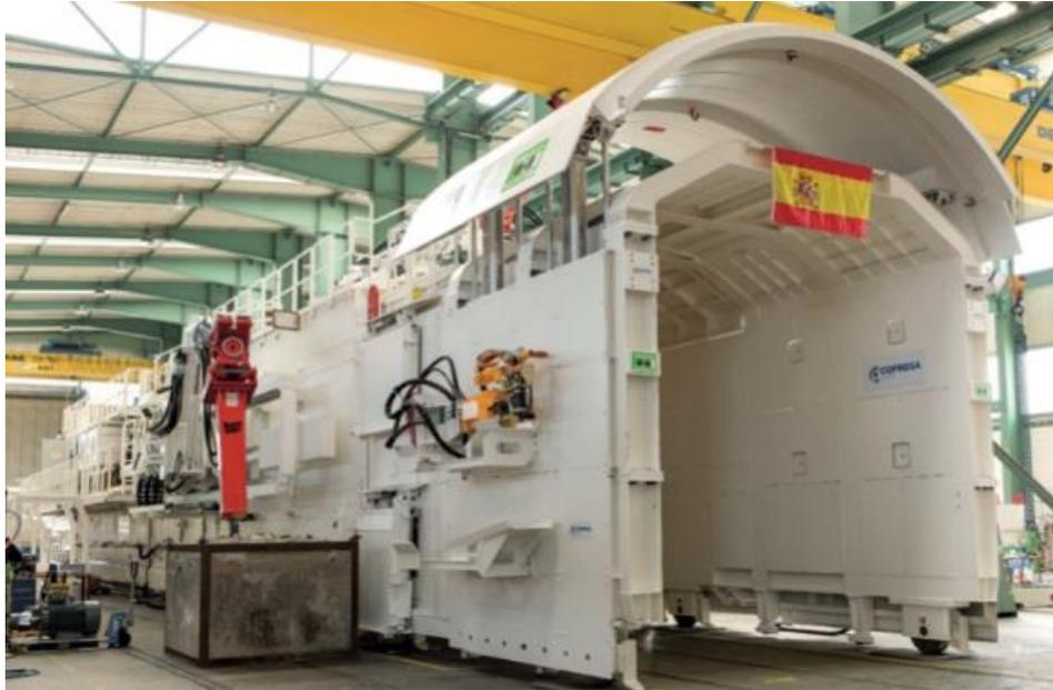
*Ilustración 83. Máquina TES Herrenknecht D-835 utilizada en túneles del tramo Irún-Astigarraga. (Suárez de la Riera, Í., 2017)*
