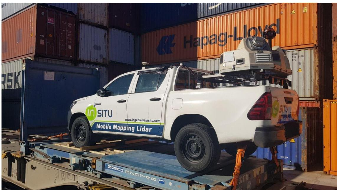
*Ilustración 67. Vehículo de mobile mapping montado en un vagón para el escaneo de la línea 200. (ADIF, 2023a)*
