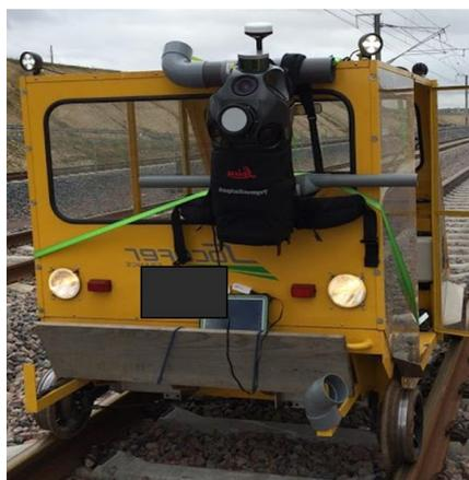
*Ilustración 69. Equipo de mobile mapping atado en la parte trasera de una dresina. (Leica Geosystems., 2019)*
