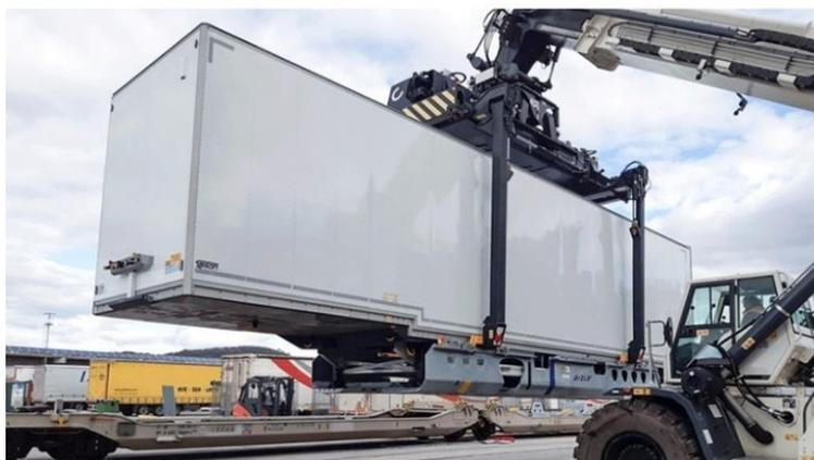
Ilustración 41. Carga de semirremolque con grúa reachstacker. (Geotren., 2024)
