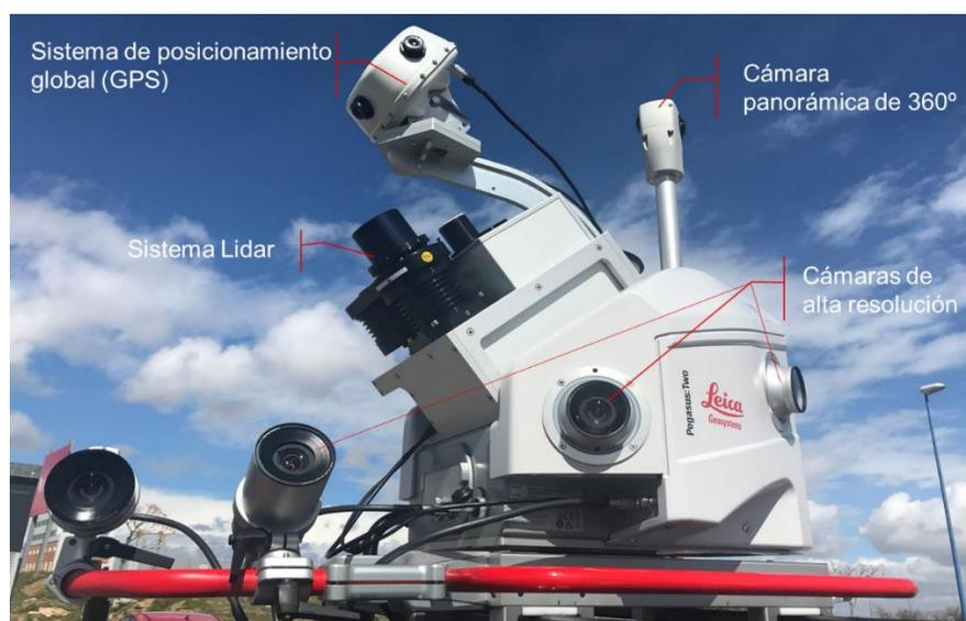
Ilustración 75. Componentes y sistemas que componen un equipo de mobile mapping apto para generar nube de puntos. (Leica Geosystems., 2019)
