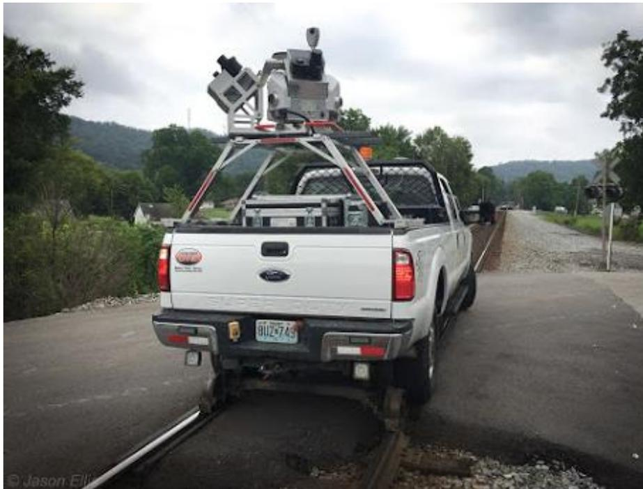
Ilustración 58. Vehículo equipado con mobile mapping. (Leica Geosystems., 2019)
