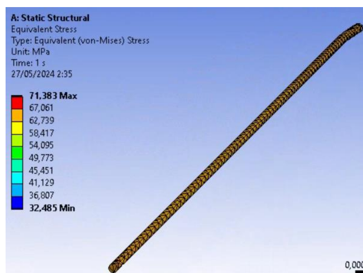
Ilustración 6.25 Tensiones equivalentes de von-Mises [Propio]
