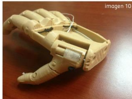
Ilustración 2.7 Mano protésica con los hilos tensores visibles (color negro y blanco) [12]
