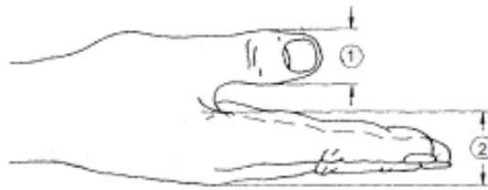
Ilustración 3.4 Dimensiones del ancho y grosor de los dedos según la Norma DIN 33 402 [16]
