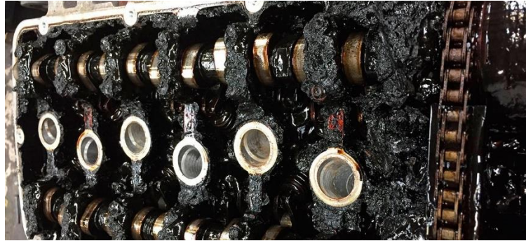
Ilustración 57 Motor con presencia de lodos y obstrucción por aceite en mal estado [126]
