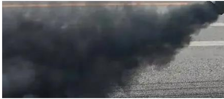
Ilustración 45 Humo negro saliendo del escape de un GEL [130]
