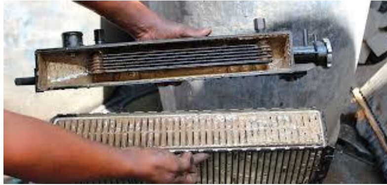
Ilustración 67 Radiador con presencia de corrosión [109]
