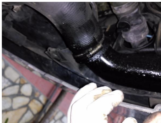
Ilustración 59 Pérdida de aceite por manguito en mal estado [125]
