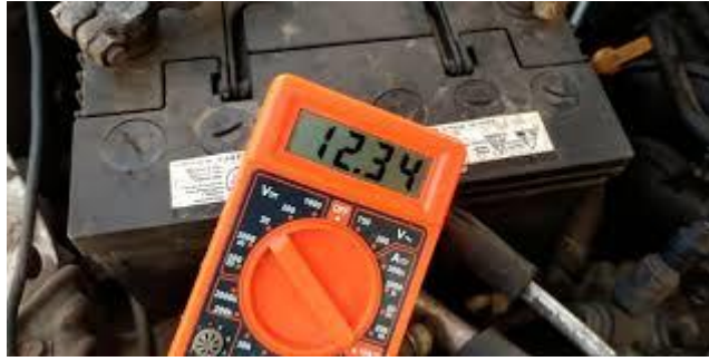
Ilustración 52 Batería en mal estado [116]
