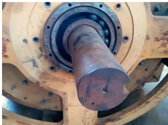
Ilustración 71 Rodamiento en mal estado, falta de grasa y bolas faltantes [105]
