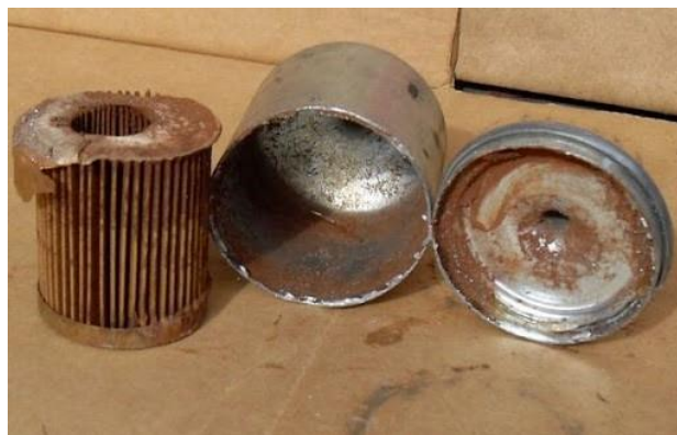
Ilustración 38 Filtro de combustible en mal estado [106]
