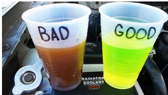
Ilustración 65 Refrigerante en mal estado y en buen estado [114]
