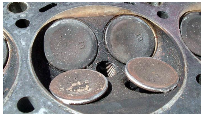
Ilustración 49 Válvulas de motor dobladas debido a un mantenimiento deficiente [128]
