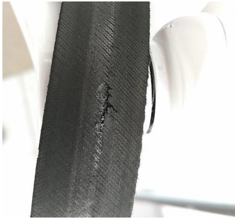
Ilustración 50 Correa de accesorios desgastada [117]
