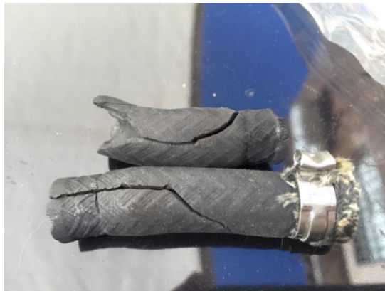
Ilustración 40 Manguito de combustible en mal estado [108]
