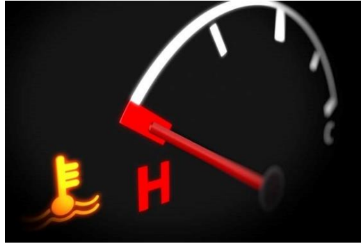
Ilustración 62 Indicador de temperatura al límite y testigo encendido [115]
