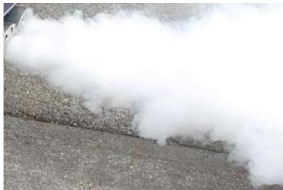
Ilustración 47 Humo blanco saliendo del escape de un GEL [132]
