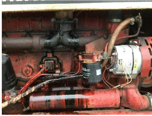
Ilustración 43 Motor de GEL sufriendo de apilamiento húmedo [134]
