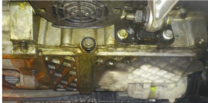
Ilustración 48 Pérdida de aceite en el motor debido a juntas en mal estado [129]
