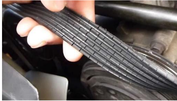
Ilustración 64 Correa del ventilador en mal estado [110]
