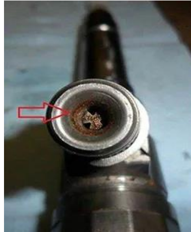
Ilustración 39 Corrosión en un inyector por la presencia de agua en el combustible [107]
