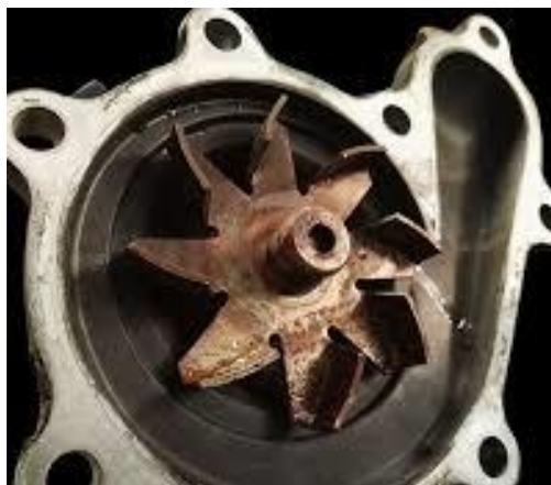
Ilustración 66 Bomba de agua con presencia de corrosión [111]
