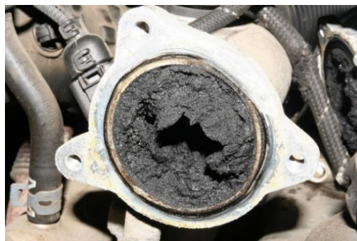
Ilustración 42 Tubería taponada por acumulación de carbonilla [75]
