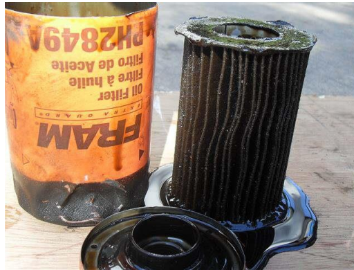
Ilustración 60 Filtro de aceite en mal estado [124]
