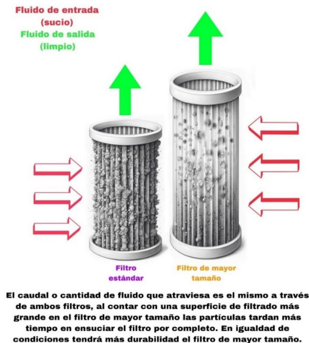
Ilustración 83 Diferencias entre filtros de diferente tamaño. Fuente: Elaboración propia [72]
