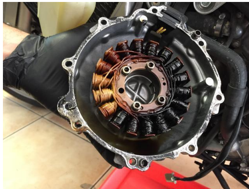
Ilustración 51 Alternador en mal estado [118]
