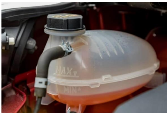
Ilustración 69 Refrigerante por debajo del nivel mínimo [113]
