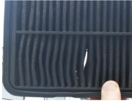
Ilustración 41 Filtro de aire sucio y con fisuras [104]
