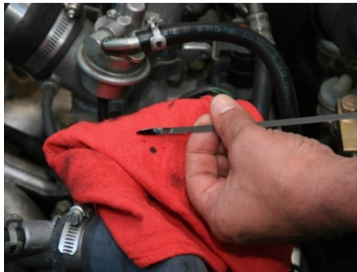
Ilustración 58 Varilla medidora indicando insuficiencia de aceite [123]
