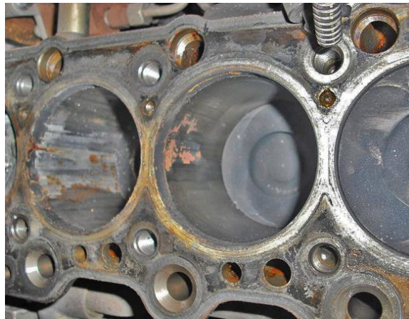
Ilustración 61 Motor gripado por falta de lubricación [127]
