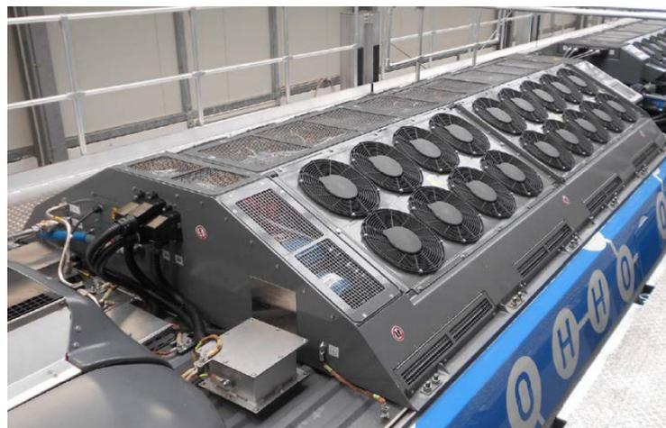
Figura 6: Pila PEM instalada en un tren Alstom. Fuente: Alstom.
