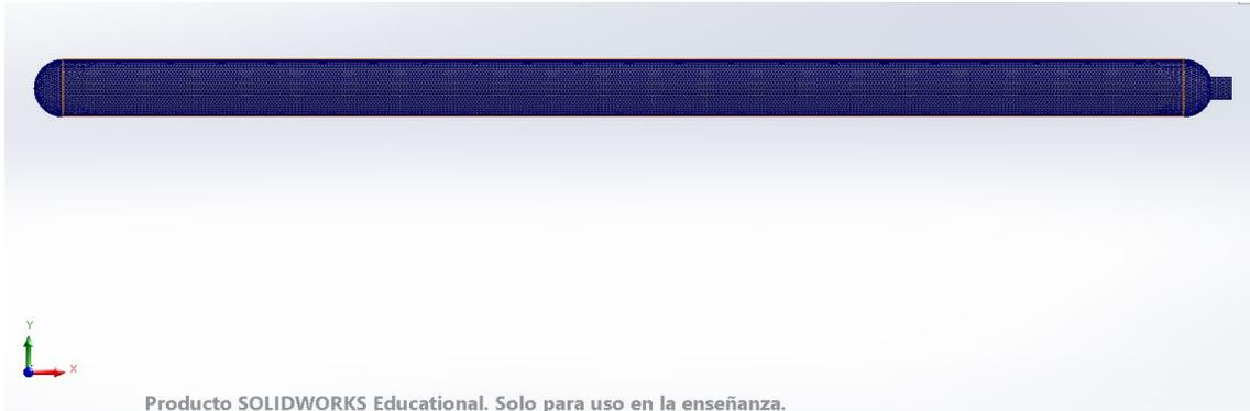
*Figura 25: Mallado del depósito*
