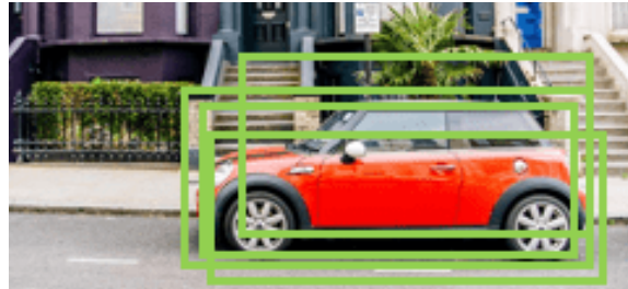
Figura 2.17: Múltiples detecciones de un mismo coche. De Jatin Prakash, 2021. En LearnOpenCV.com.
