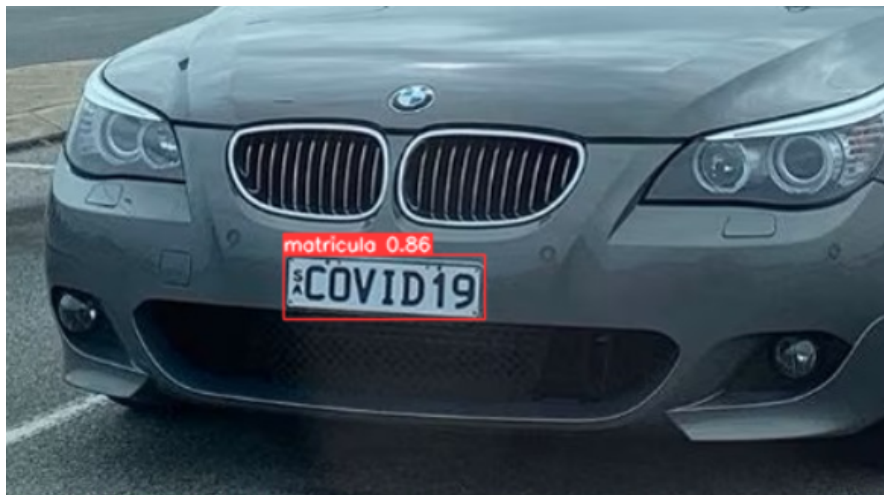
Figura 3.26: Imagen con una detección de matrícula mediante YOLOv8. Elaboración propia.
