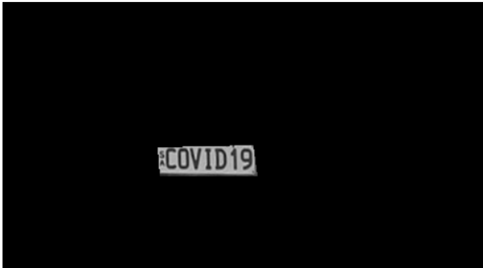
Figura 3.12: Máscara con la detección de la matrícula aplicada a la imagen original. Elaboración propia.
