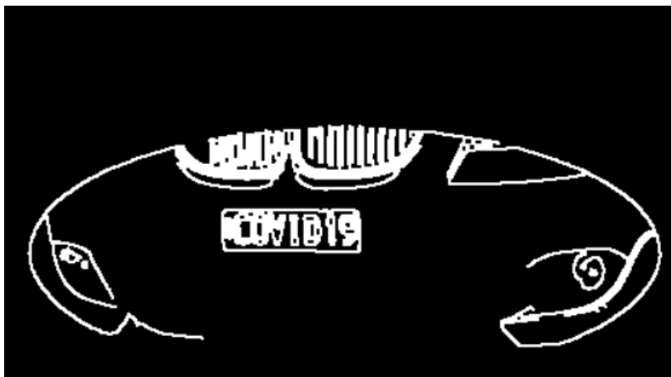
Figura 3.10: Imagen con el detector de bordes Canny con Open. Elaboración propia.
