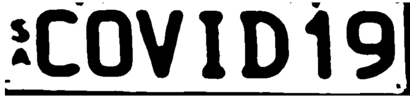
Figura 3.51: Imagen de la matrícula tras el preprocesado. Elaboración propia.
