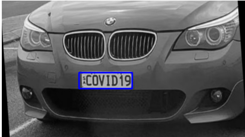
Figura 3.20: Bounding box con la detección de la matrícula en la imagen de ejemplo mediante reconocimiento de patrones. Elaboración propia.
