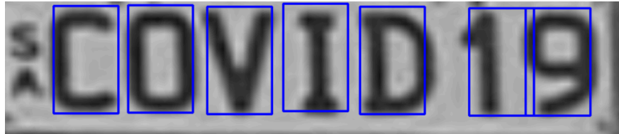
Figura 3.39: Imagen de la matrícula con las detecciones de cada glifo. Elaboración propia.
