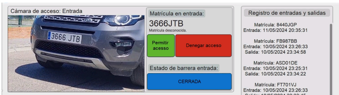
Figura 4.6: Detección de un vehículo no registrado en la base de datos. Elaboración propia.
