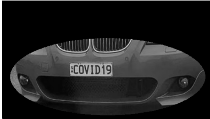
Figura 3.8: Imagen con la máscara de preprocesado aplicada. Elaboración propia.
