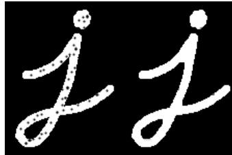
Figura 2.14: Operación de open sobre imagen de ejemplo con ruido. De docs.opencv.org .
