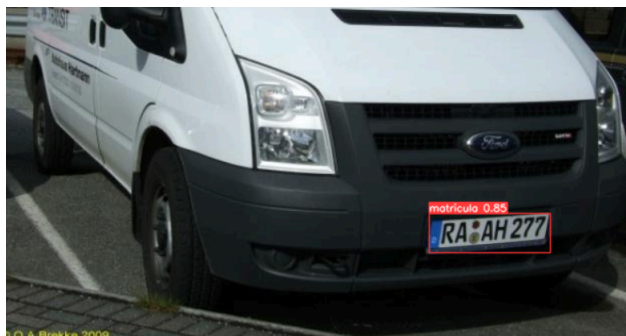
Figura 3.62: Detección de una matrícula en la imagen de la furgoneta mediante el modelo de predicción de YOLOv8. Elaboración propia.
