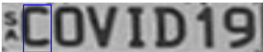
Figura 3.38: Imagen de la matrícula con las múltiples detecciones eliminadas. Elaboración propia.
