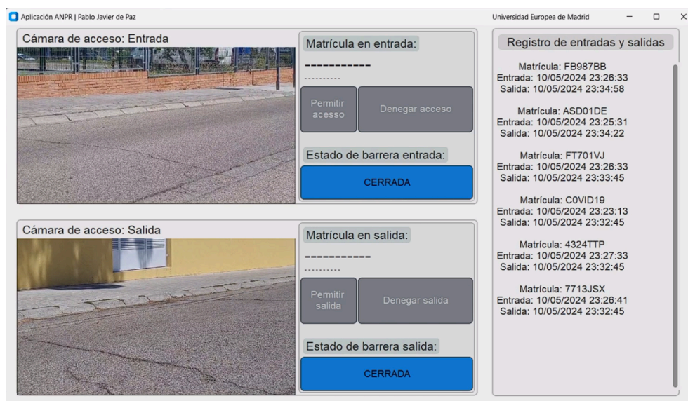
Figura 4.4: Pantalla de operación estándar de la HMI. Elaboración propia.
