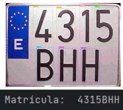
Figuras 3.49 y 3.50: Matrícula de dos filas y la cadena de texto extraída de ella en la consola de Python. Elaboración propia.
