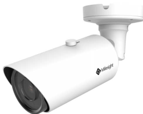
Figura 2.2: Cámara Pro Bullet LPR X12 Motorizada 120fps H.265+ 2Mpx, de ESSistemas.
