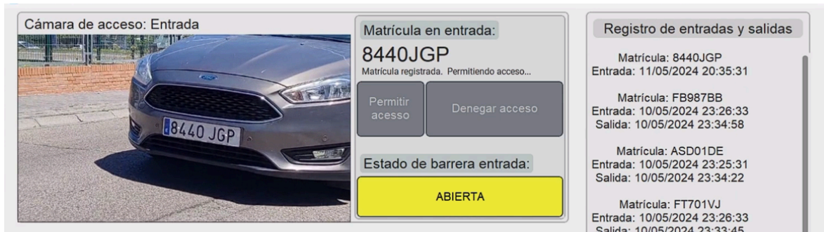
Figura 4.5: Detección de un vehículo registrado en la base de datos. Elaboración propia.
