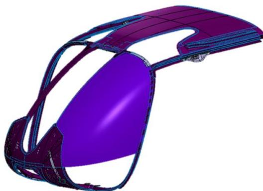
Figura 42: Superficie de la carrocería y las ventanillas del H130
