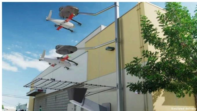
Figura 7. Estación de carga autónoma de Zipline para su dron P2. Fuente: [52]
