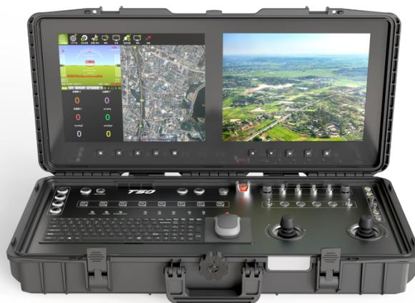
Figura 2.8: Estación de control de tierra.
