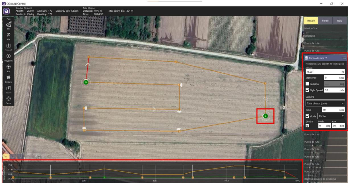
Figura 4.9: Edición de parámetros en la planificación de misión en QGroundControl.
