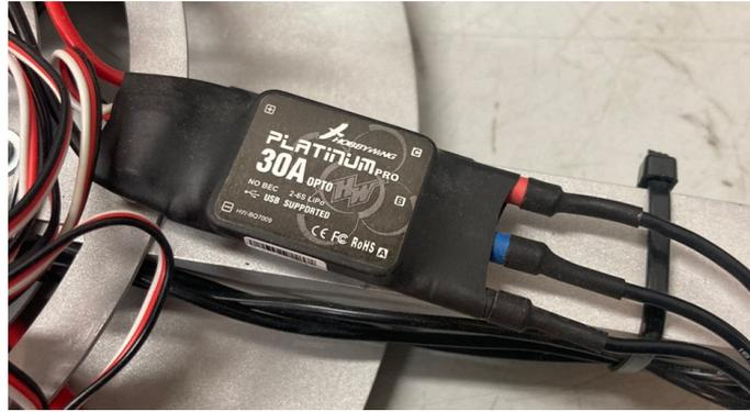
Figura 2.17: ESC utilizado en el proyecto.
