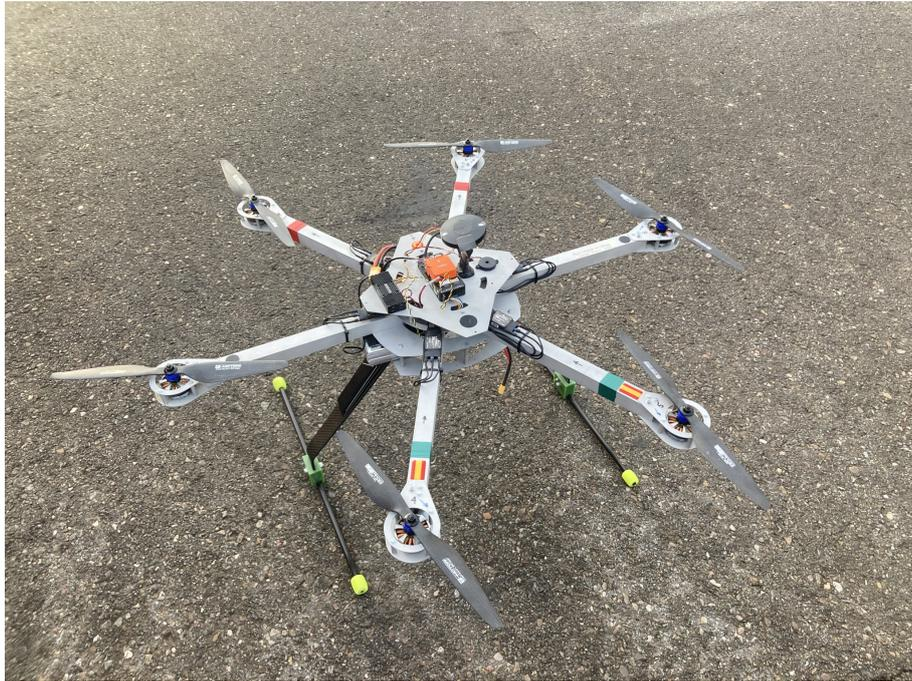
Figura 3.13: Foto del hexacóptero ensamblado.
