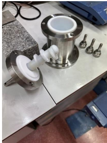
Figura 19. Molino de atricción con todas sus piezas
