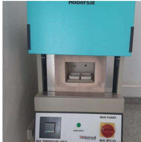
Figura 26. Horno encargado de la calcinación
