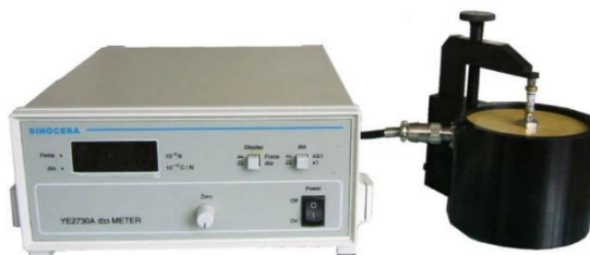
Figura 17. Aparato para medir la constante piezoeléctrica d_{33}
