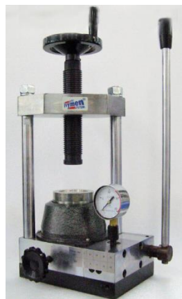
Figura 29. Prensa axial PM-15 utilizada en este trabajo
