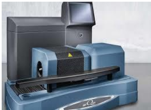
Figura 11. Imagen del aparato TG-DSC Q600 TA
