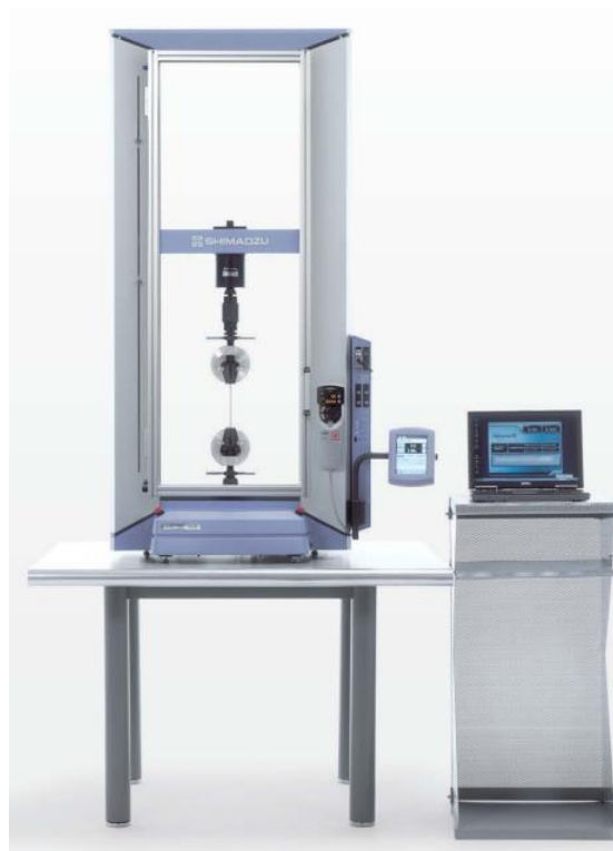
Figura 15. Imagen del aparato utilizado para los ensayos a flexión (AG-X5kN)
