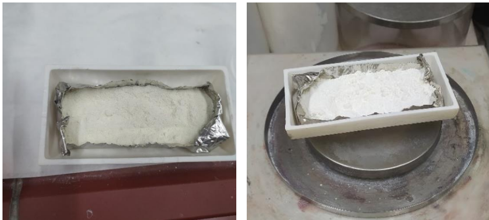
Figura 27. Material antes de ser calcinado. Material tras su calcinación
