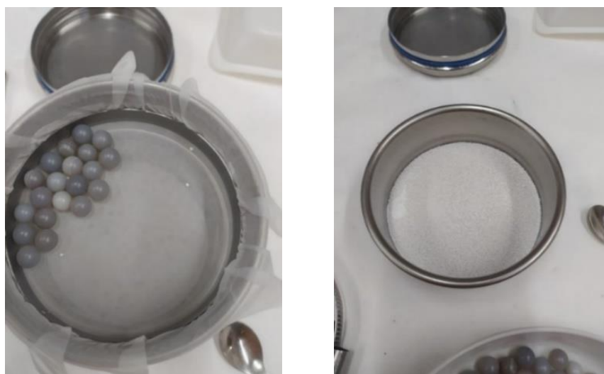
Figura 24. Tamiz y resultado tamizado tras el proceso de tamización
