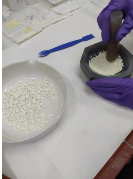
Figura 25. Molido a mano con el uso de un mortero de ágata
