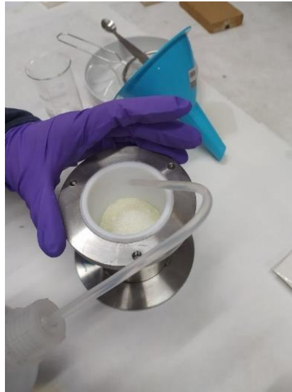
Figura 18. Molino de atricción completando su llenado
