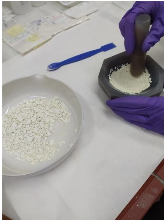
Figura 22. Molido a mano con el uso de un mortero de ágata
